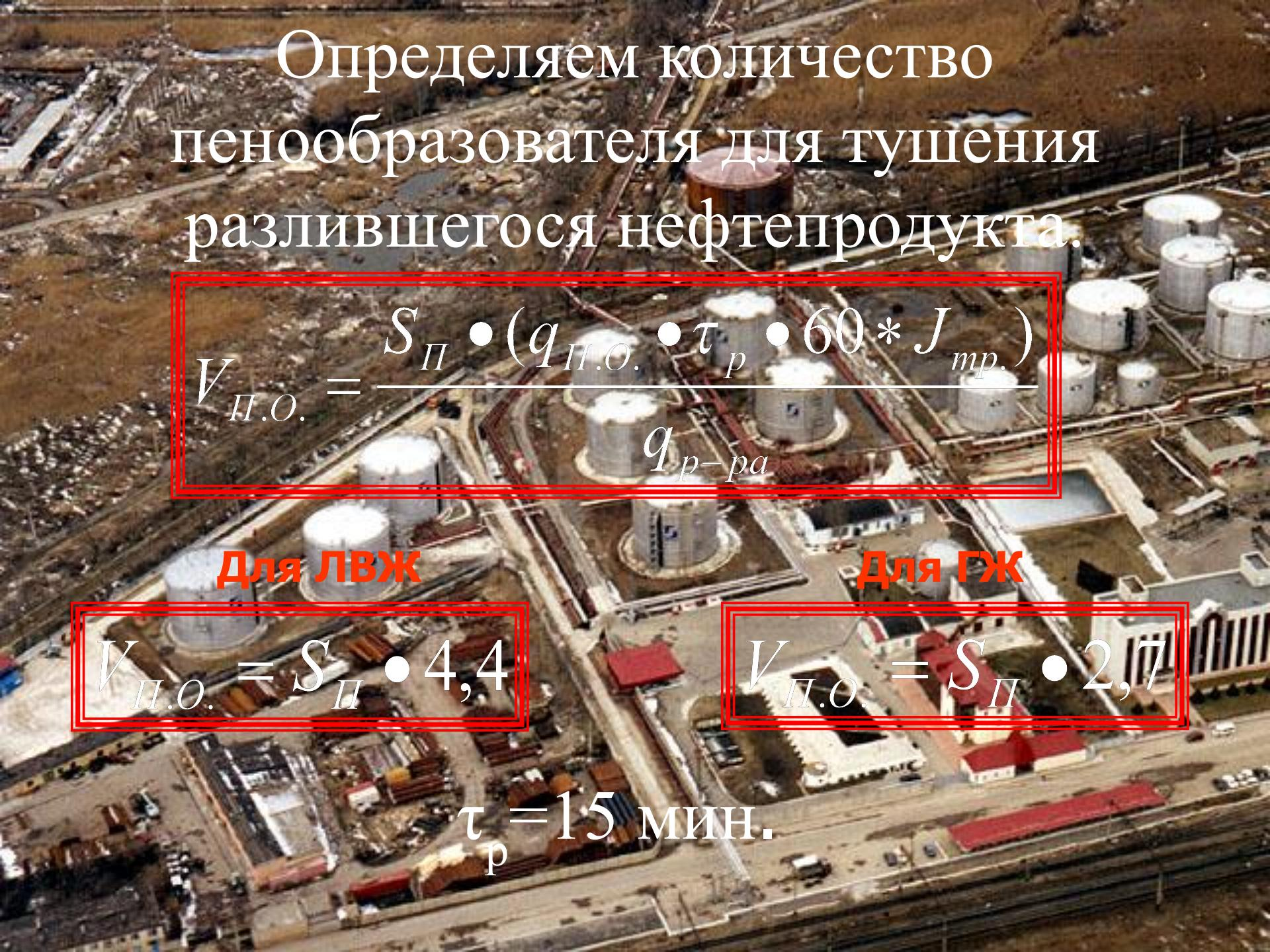
Определяем количество пенообразователя для тушения разлившегося нефтепродукта.
