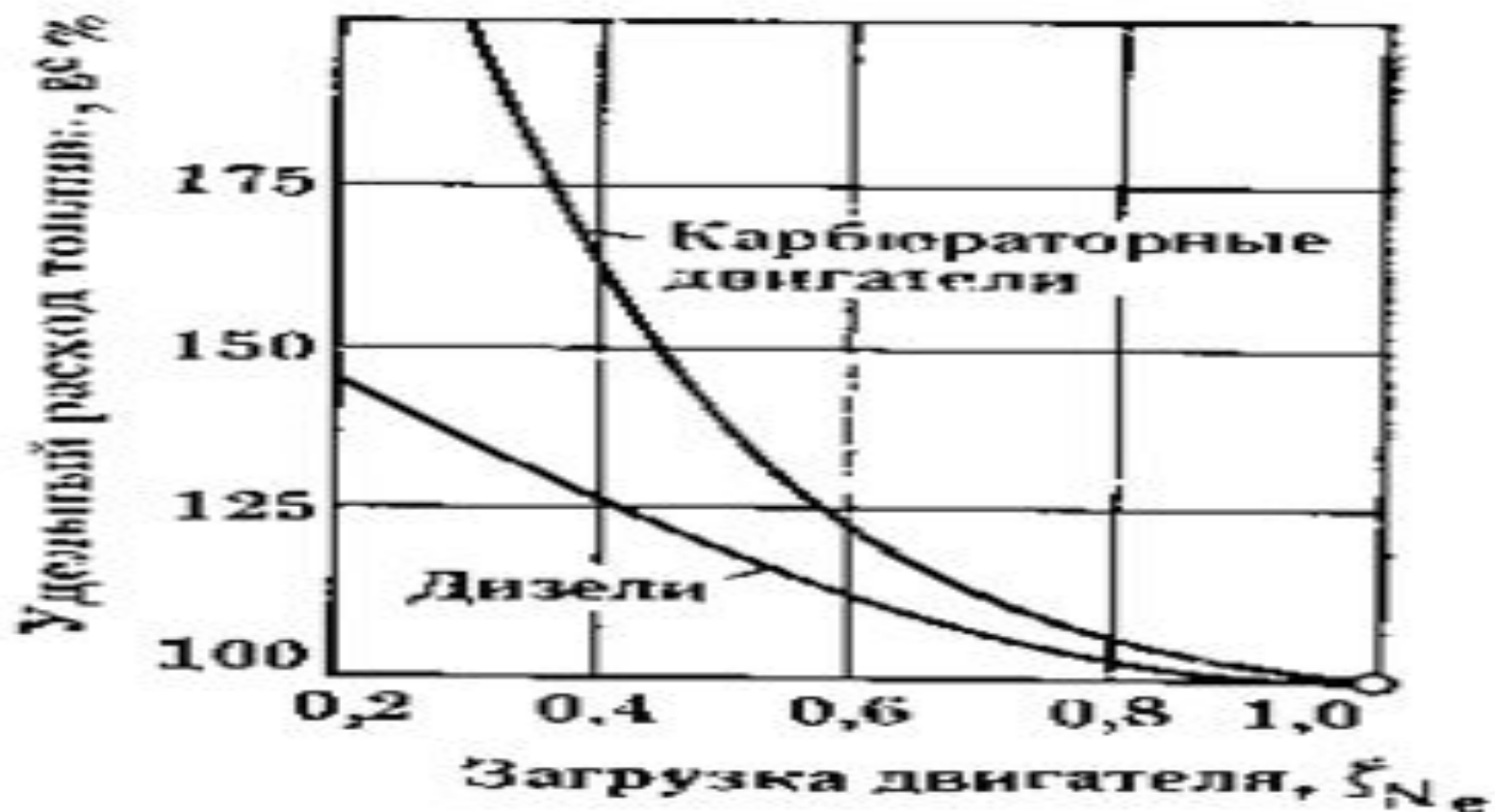
Рис. 1.34. Характер изменения удельного расхода топлива в зависимости от степени загрузки двигателя.
