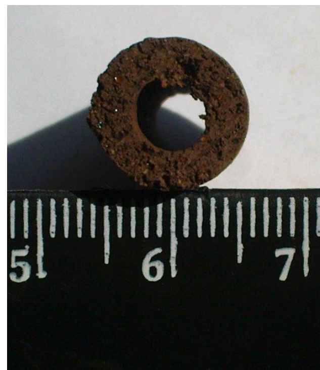
трубчатый катализатор ( d_{\text{вн}}=5\text{мм} , h=30\text{мм} , \delta=2\text{мм} )
