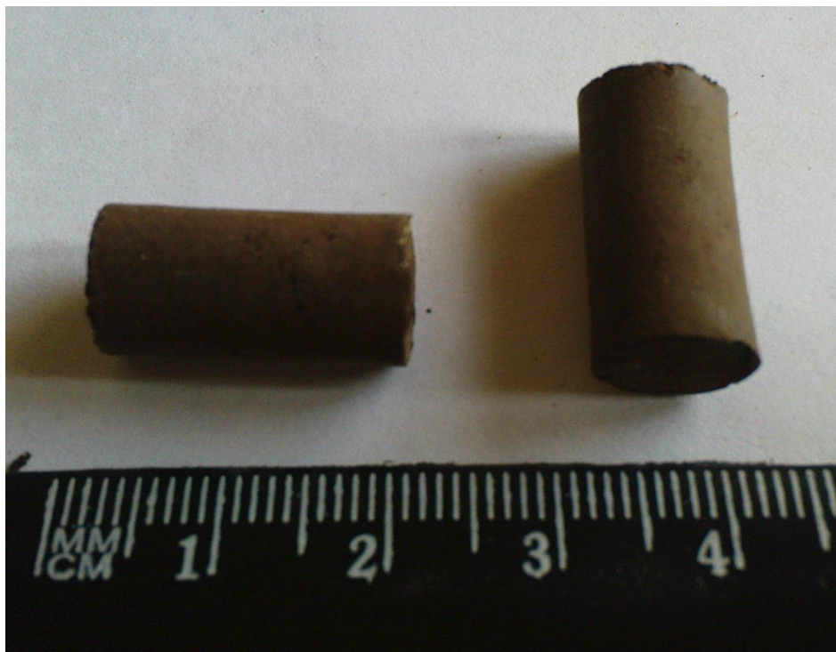
гранулированный ( d=5\text{мм} , h=10\text{мм} )
