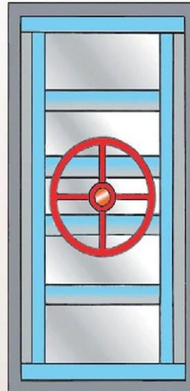
ПРОТИВОВЗРЫВНОЕ УСТРОЙСТВО ПЛАСТИНЧАТОГО ТИПА (МЗС)
