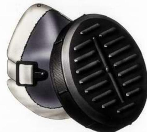
Респиратор многоразового использования со сменным фильтром. Защищает от силикатной, металлургической, горнорудной, угольной, табачной пыли, пыли порошкообразных удобрений и интоксидов, не выделяющих токсических газов. Широко применяется шахтёрами при высокой запылённости. Масса — 250 г.
