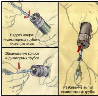
Надрез концов индикаторных трубок с помощью ножа
