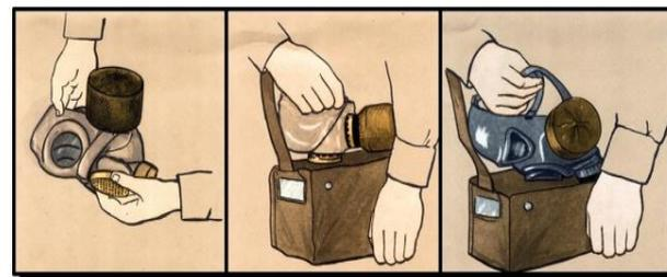
Для укладки противоголоза ПМГ взять противоголоз за переговорное устройство, уложить шлем внутрь маски, сложить её по осевой линии, уложить в сумку коробкой от себя.
