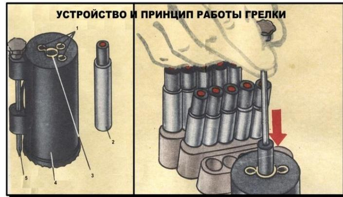
1. Боковые гнезда; 2. Патрон грелки; 3. Центральное гнездо; 4. Корпус грелки; 5. Штырь.
