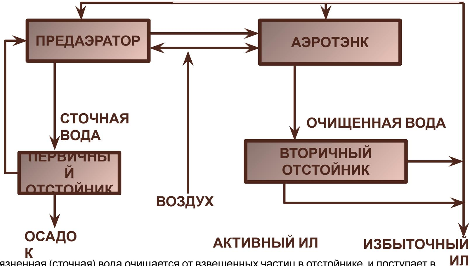
Загрязненная (сточная) вода очищается от взвешенных частиц в отстойнике и поступает в предаэратор. Туда же подается часть активного ила (около 10 % общего расхода) и воздух. Примерно 20 мин воздух перемешивает активный ил с водой, после чего смесь подается в главный аппарат очистки — аэротенк.
