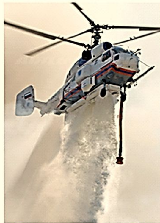
Пожарно-спасательный вертолет Ка-32А. Сброс воды
