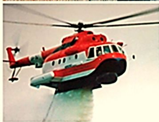
Авиационный комплекс тушения наземных пожаров на базе вертолета МИ-14ПЖ
