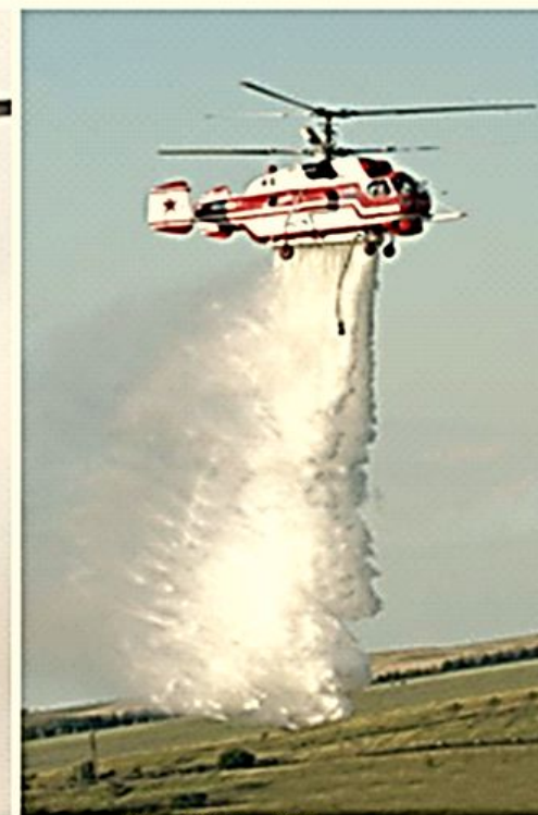
Пожарно-спасательный вертолет Ка-32А. Сброс воды
