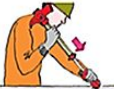
Рис. 5.48 Разрезание листового металла кровли
