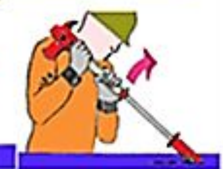
Рис. 5.48 Разрезание стальной балки в углу
