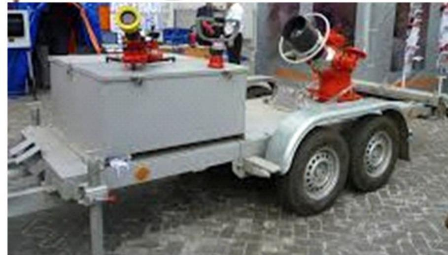
**Водомет базируется на прицепе, позволяющем оперативно доставлять оборудование к месту пожара. Все работы по установке, подключению и управлению производятся одним человеком.**
