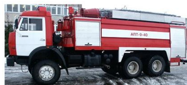
Пожарный автомобиль пенного тушения (АПТ)
