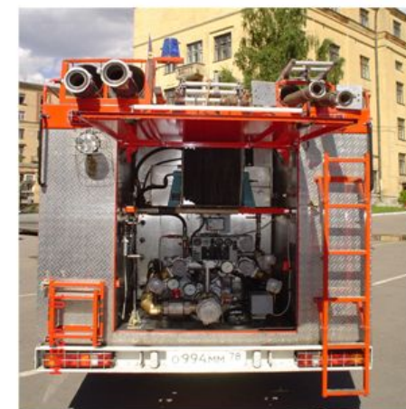
Пожарный автомобиль с насосом высокого давления (АВД)
