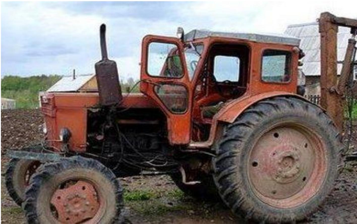
Основными источниками шума на тракторах являются: двигатель, выхлопная система, топливная аппаратура и коробка клапанов.
