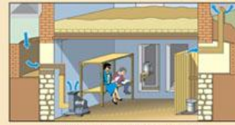
Подвал одноэтажного здания, приспособленный под противорадиационное укрытие
