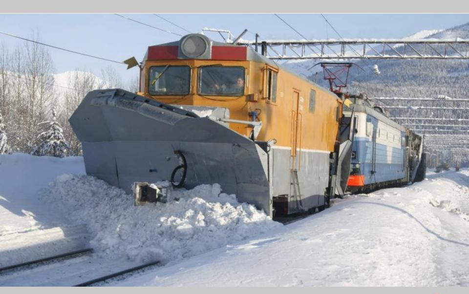
Очистка путей от снега на промежуточных станциях также производится снегоочистителями и стругами.
