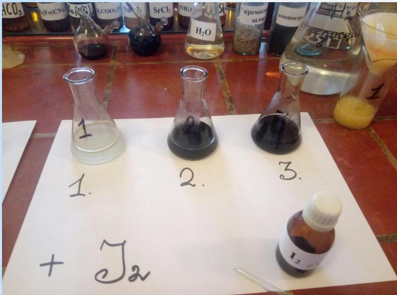
Налили в пробирку 50 мл водной вытяжки и добавили 2-3 капли 3 %-ного спиртового раствора йода.
