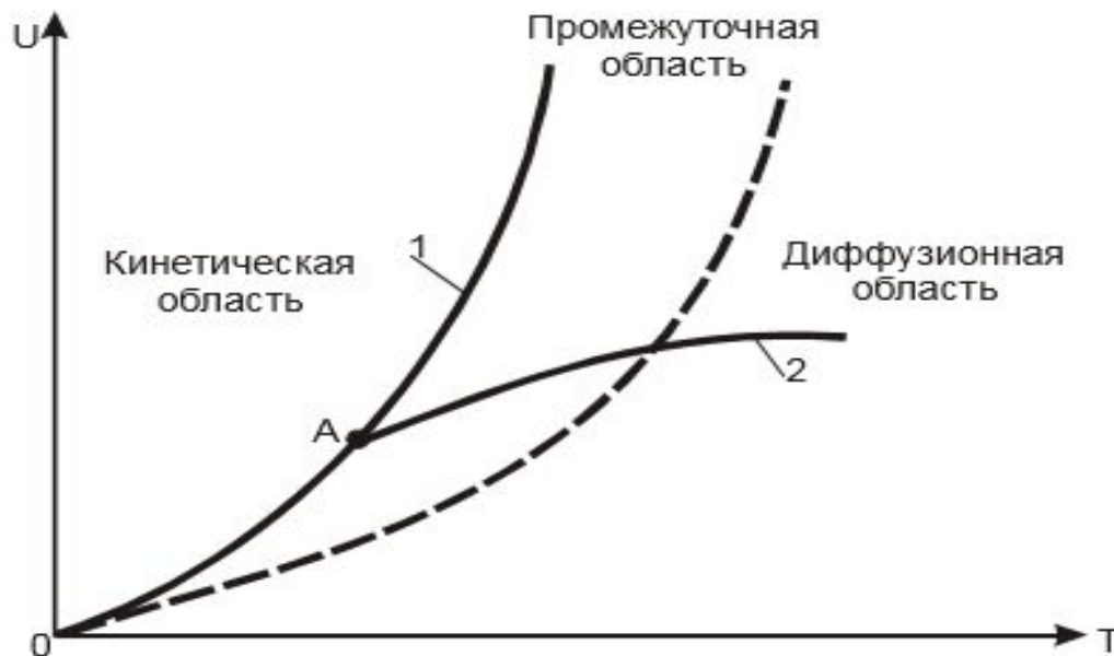
Рис. 1.5. Зависимость скорости U кинетического (1) и диффузионного (2) режимов от температуры. Точка A – переход из кинетической области в диффузионную
