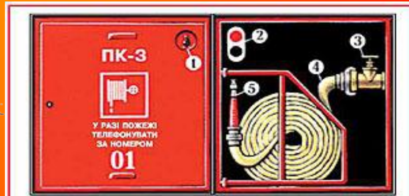
Рисунок 2. Внутрішній пожежний кран: 1 – місце зберігання ключа; 2 – пульт дистанційного запуску насоса-підвищувача; 3 – пожежний кран; 4 – пожежний рукав; 5 – ствол.
