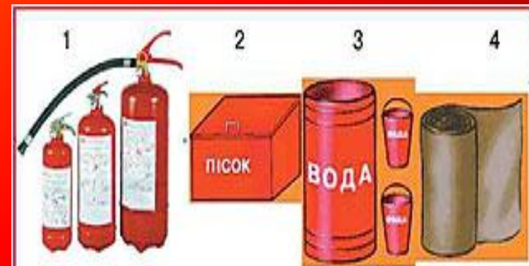
Рисунок 6. Первинні засоби пожежогасіння: 1 – вогнегасники; 2 – ящик з піском; 3 – бочка з водою та відра; 4 – покривало пожежне.
