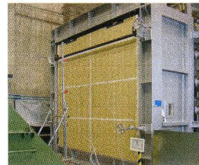
Испытания по огнестойкости стен
