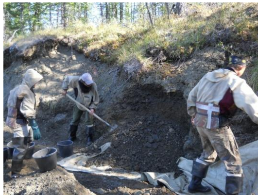
Отмывка пробы до черного шлиха
