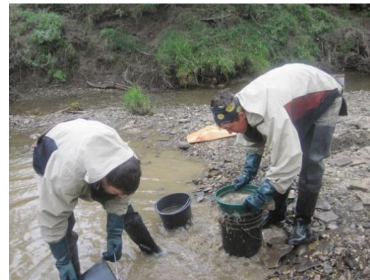
Просеивание пробы через сита 6 и 5 мм
