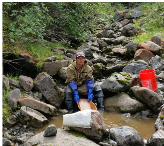
Отмывка пробы до черного шлиха
