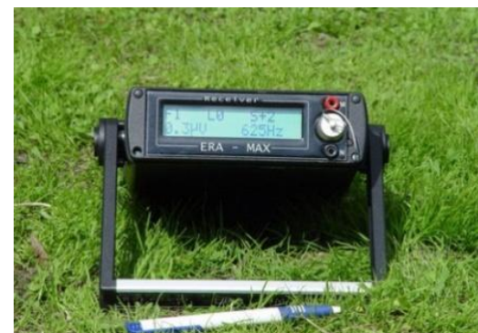
Рис. Измеритель для электроразведки «ERA-MAX»
