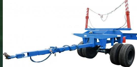
транспортное средство, не оборудованное двигателем и предназначенное для движения в составе с механическим транспортным средством. Термин распространяется также на полуприцепы и прицепы-роспуски.
