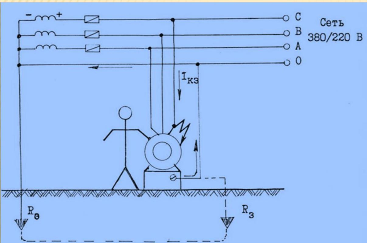
**Защитное заземление** - это преднамеренное электрическое соединение с землей или ее эквивалентом металлических нетоковедущих частей электроустановки, которые могут оказаться под напряжением
