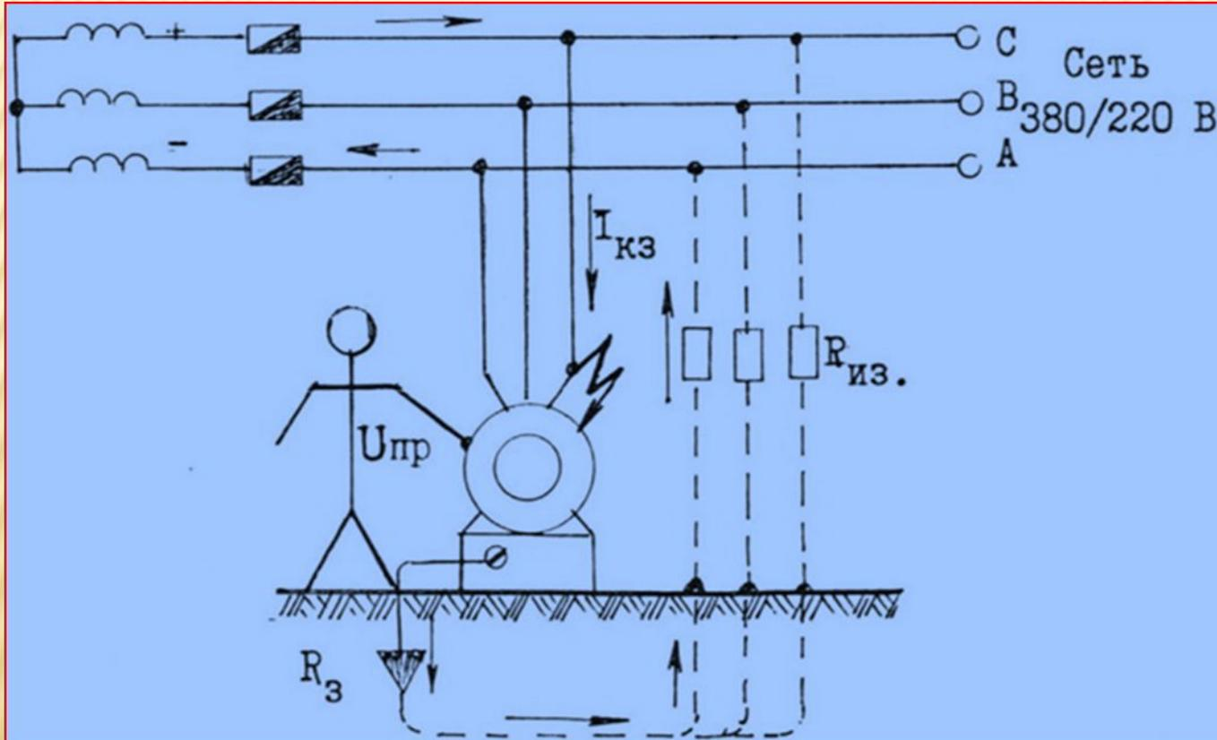
**Защитное отключение** - это быстродействующая защита, обеспечивающая автоматическое отключение электроустановки при возникновении опасности поражения током.
