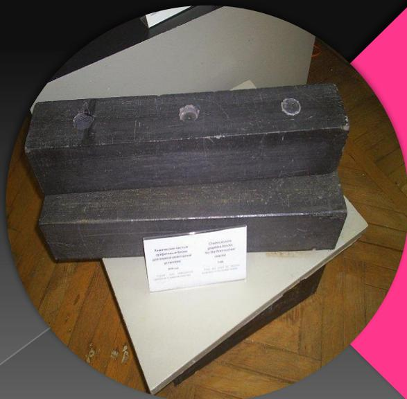
Первый ядерный реактор представлял собой сплюснутый эллипсоид диаметром 8 м и высотой 6 м, сложенный из 385 т графитовых брикетов, между которыми на расстоянии 21 см друг от друга было размещено 46 т урановых блоков весом 2 кг каждый, то есть в целом реактор был похож на кристалл с кубической решеткой.
