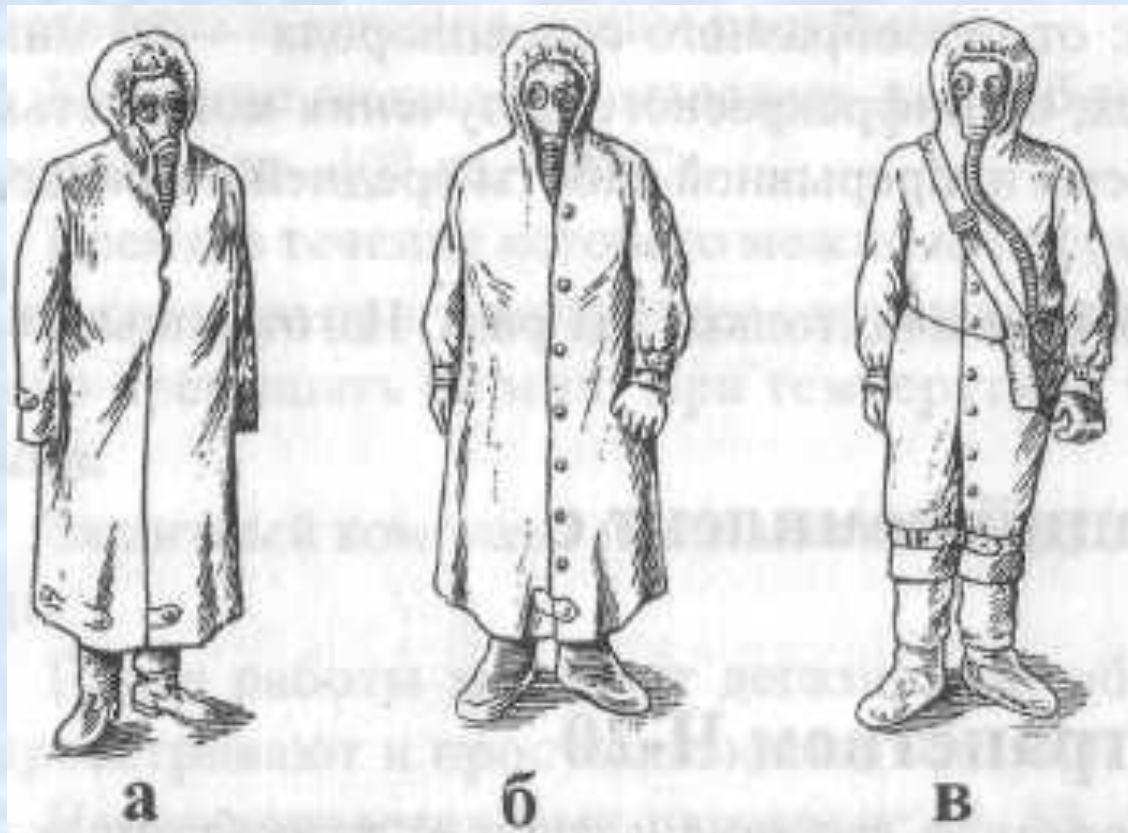
Рис. 10: Общевойсковой защитный комплект в трех положениях: а – в виде накидки; б – надетым в рукава; в – в виде комбинезона.
