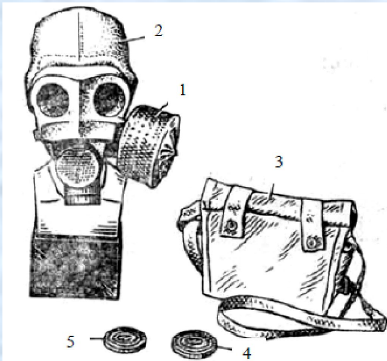
Рис. 2. Противогаз ПМГ: 1 – фильтрующе-поглощающая коробка ЕО-18к (ЕО-62к) в чехле; 2 – шлем-маска ШМГ; 3 – сумка; 4 – незапотеваяющие пленки; 5 – мембраны переговорного устройства
