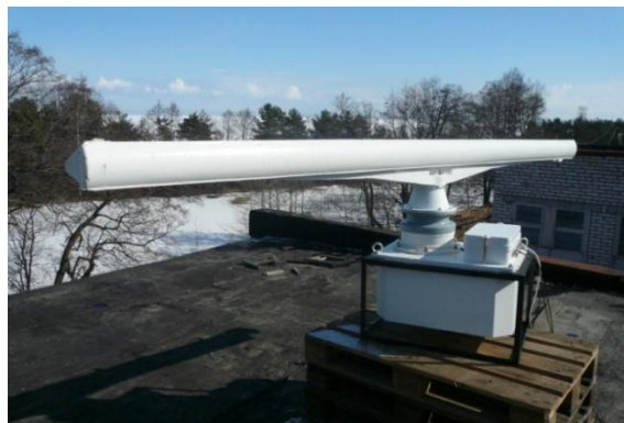
РЛС (канал большой дальности КБД) до 40 км
