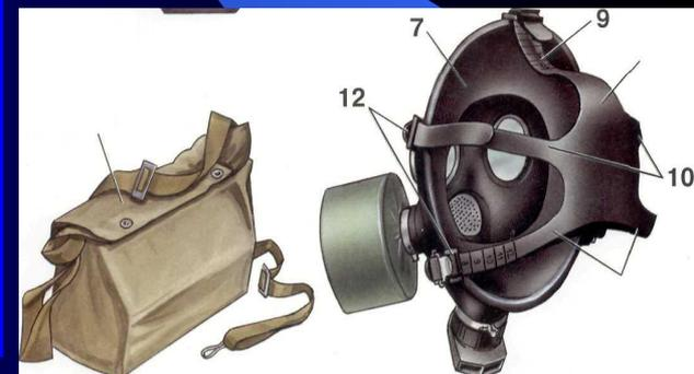
ГП-7 по сравнению с ГП-5 имеет ряд преимуществ по защитным, эксплуатационным и физиологическим показателям. обеспечивает защиту от радионуклидов йода. В нем уменьшено сопротивление фильтрующе-поглощающей коробки, что облегчает дыхание. Затем, «независимый» обтюратор обеспечивает более надежную герметизацию и в то же время уменьшает давление лицевой части на голову.
