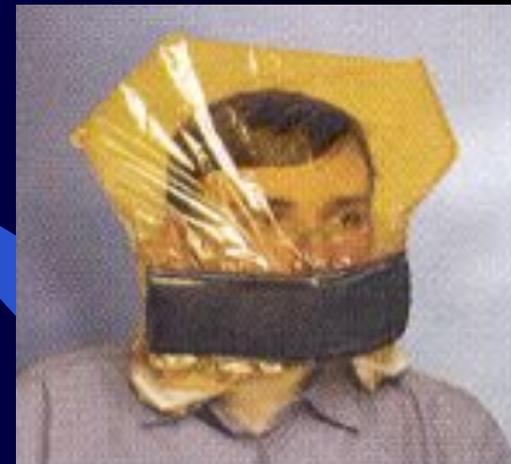
Предназначен для защиты органов дыхания, глаз и кожи лица от аэрозолей, паров и газов опасных химических веществ (в том числе продуктов горения) при аварийных ситуациях в жилых, служебных, промышленных зданиях, а также для эвакуации из задымленных помещений. Обеспечивает защиту в течении 20мин при ПДК в 50-70 раз
