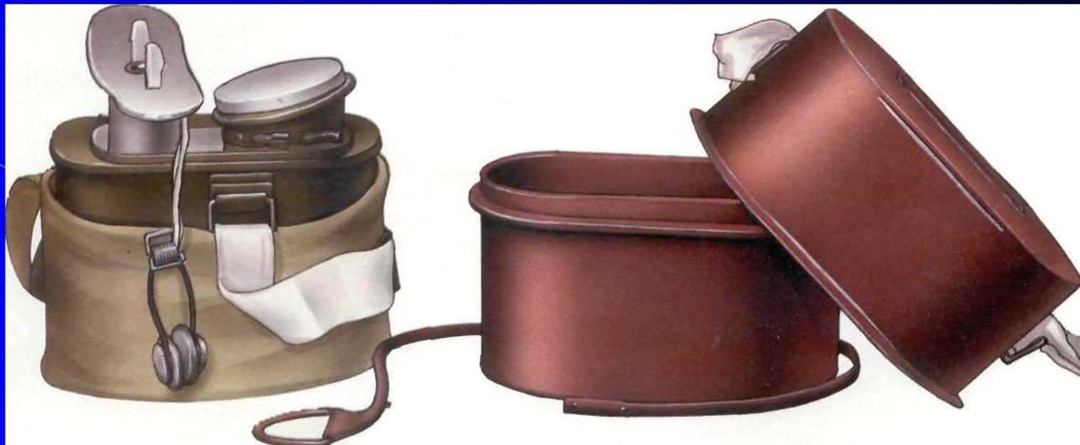
Предназначен для защиты органов дыхания горнорабочих от вредного воздействия оксида углерода а также пыли и дыма, при выходе из загазованных участков. Время защитного действия по оксиду углерода СПП-4 — 120 мин, а СПП-5 — 60 мин. Масса — 1,1 кг.
