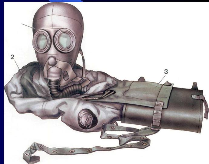
Запас кислорода в регенеративном патроне позволяет выполнять работы при тяжелых физических нагрузках в течение 45 мин, при средних - 70 мин, а при легких или в состоянии относительного покоя - 3 часа.
