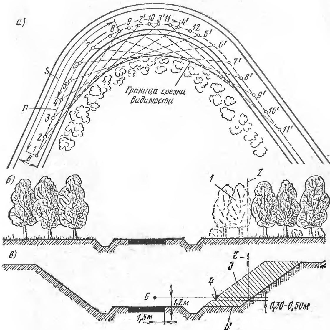
Расстояние от траектории движения автомобиля до вертикальной линии срезки в середине
