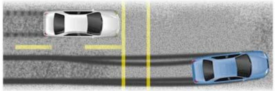
Тормозной путь – величина пути, на котором водитель может остановить автомобиль, движущийся с расчетной скоростью
