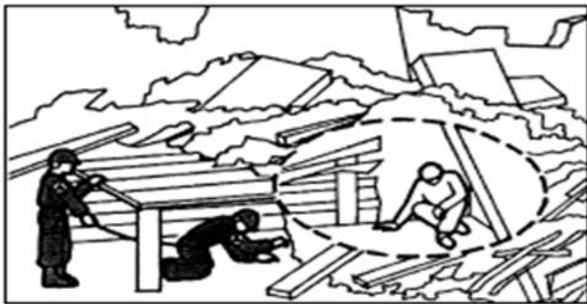
Устройство лаза в завале
