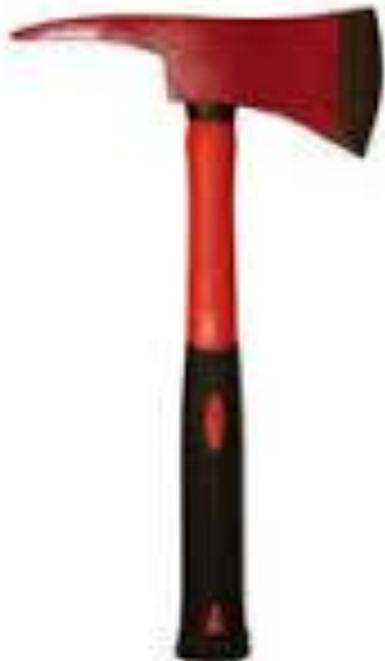
Топор пожарный поясной имеет лезвие 2 и кирку 3. Его лезвие предназначено для разборки деревянных конструкций. Кирка используется для проделывания отверстий в кирпичных и бетонных конструкциях, передвижения пожарных по скатам крыш.
