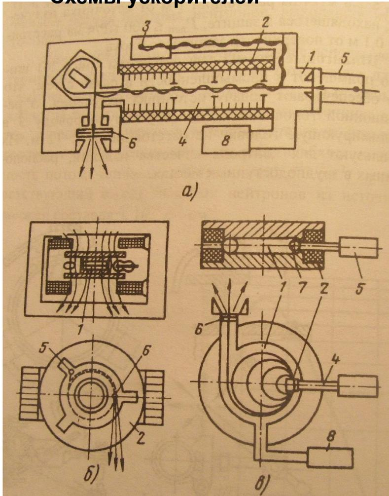
а – линейный ускоритель, б – бетатрон, в – микротрон;
