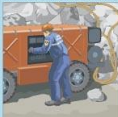
Подача воздуха в заваленные защитные сооружения с порожденными фильтра-вентиляционными системами
