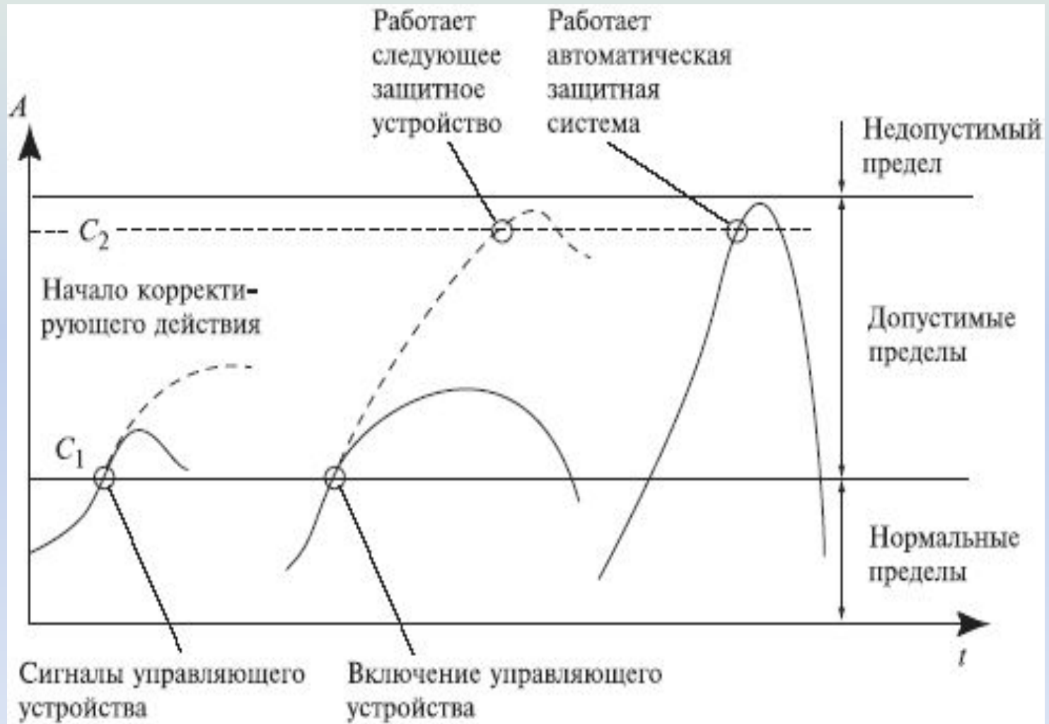
Рис. 1. Схема работы защитных устройств в системе тройного контроля: A - переменные характеристики процесса; t - время.
