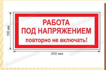
«РАБОТА ПОД НАПРЯЖЕНИЕМ повторно не включать!» - этот знак запрещает повторное ручное включение выключателей ВЛ без согласования с руководителем работ после того, как они были автоматически отключены. Такие плакаты вывешиваются на ключи управления выключателей ВЛ, когда выполняются ремонтные работы под напряжением.
