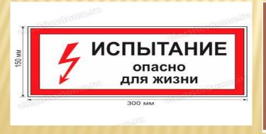
«ИСПЫТАНИЕ опасно для жизни» плакат предупреждает об опасности поражения действием электрического тока при проведении высоковольтных испытаний. Такие знаки вывешиваются на ограждениях рабочих мест во время проведения высоковольтных испытаний.
