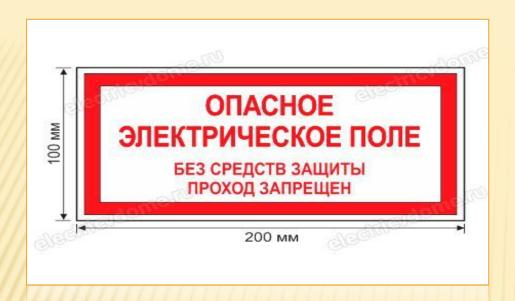
«ОПАСНОЕ ЭЛЕКТРИЕСКОЕ ПОЛЕ без средств защиты проход запрещен» предупреждающий плакат, опасного воздействия возможности электрического поля на обслуживающий персонал, a также запрещает передвижение людей без применения средств защиты. Устанавливается в ОРУ, в которых напряжение превышает 330 кВ на высоте 150 - 200 см на ограждениях участков, напряженность где электрического поля превышает 15 кВ/м.
