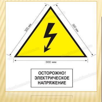
«ОСТОРОЖНО электрическое напряжение» - знак электробезопасности, предупреждающий об опасности поражения действием электрического тока. Вывешивается в электроустановках любого класса и подкласса подстанций и электростанций.
