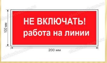
«НЕ ВКЛЮЧАТЬ! работа на линии» плакат переносной, запрещающий подачу на линию напряжения. Вывешивается на ключах и приводах управления коммутационных аппаратов, включение которых может подать на линию напряжение.
