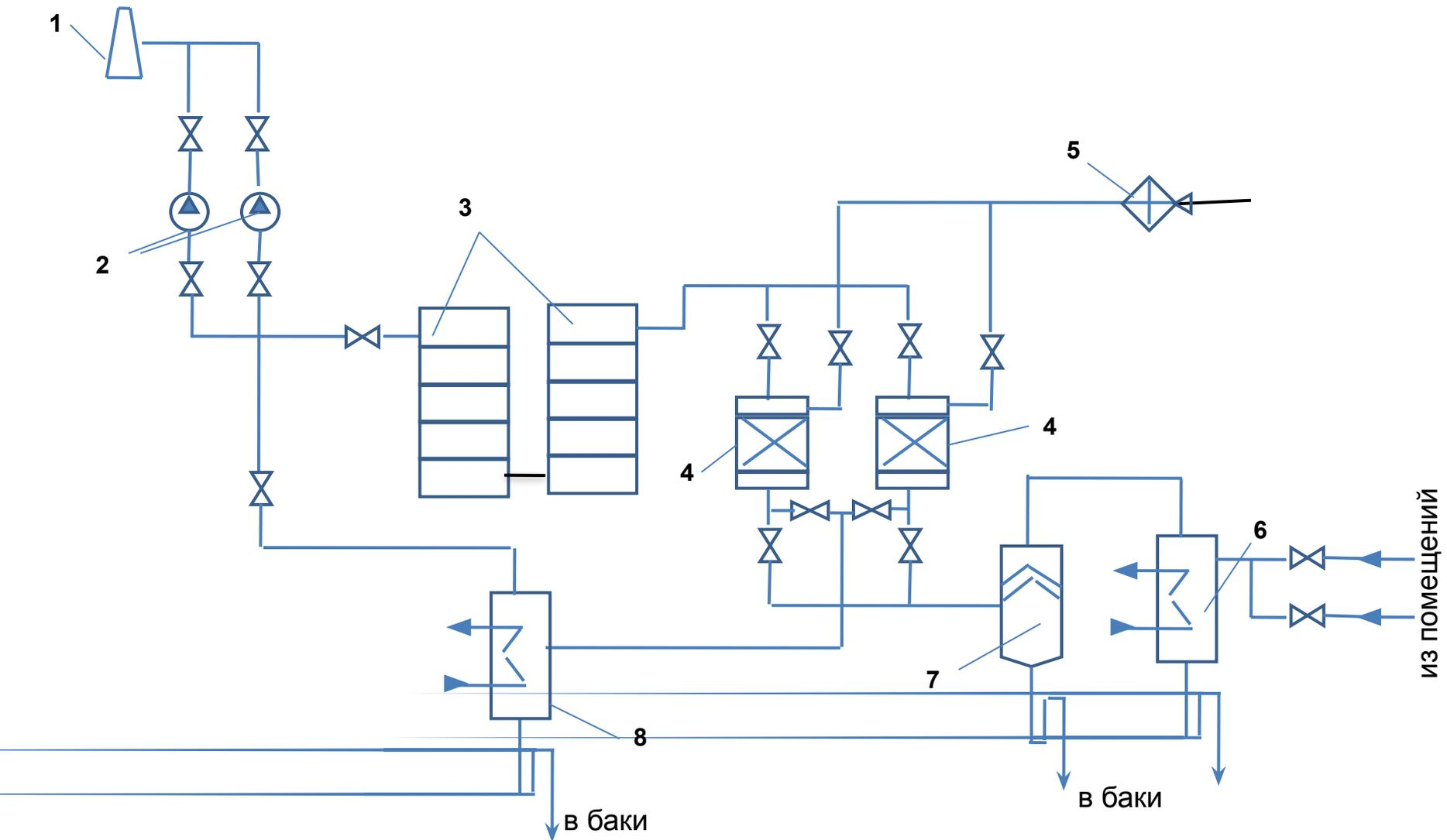
1- Вентиляционная труба, 2 – газодувка, 3- фильтр-адсорбер, 4- цеолитовый фильтр, 5- нагреватель контура регенерации, 6- теплообменники, 7- самоочищающийся фильтр, 8- теплообменник контура регенерации
