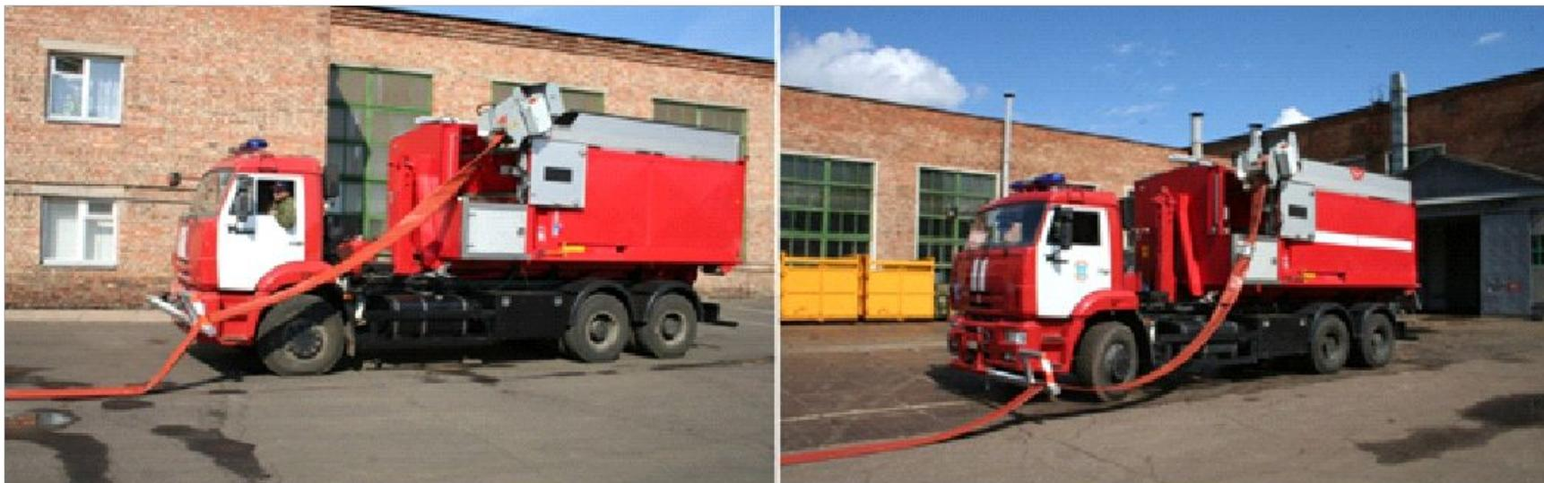
Данный комплекс имеет облегченные характеристики: базируется на шасси одного автомобиля и состоит из насосного и рукавного модулей, установленных на единую транспортную платформу.
