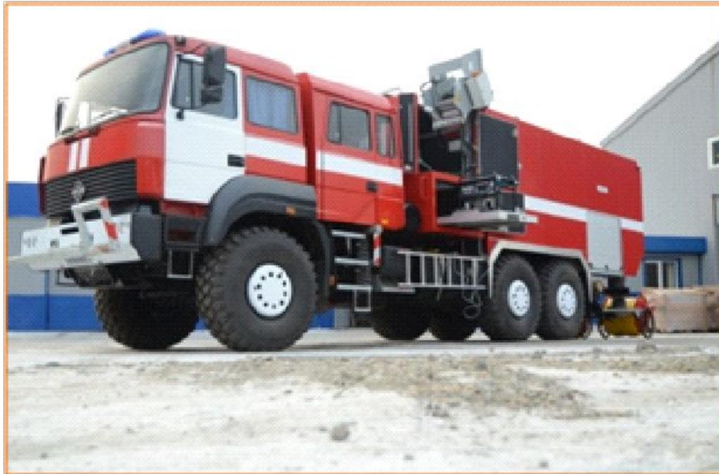
Его техническая особенность заключается в том, что он является одновременно пожарной автоцистерной (емкость – 4 м<sup>3</sup>), передвижной насосной станцией (производительность – до 130 литров в секунду) и рукавным автомобилем (длина магистральной линии – 1,2 километра). Высокая эффективность комплекса «Магистраль» достигается как эргономичной компоновкой узлов и агрегатов, так и наличием двухступенчатой системы подачи воды.
