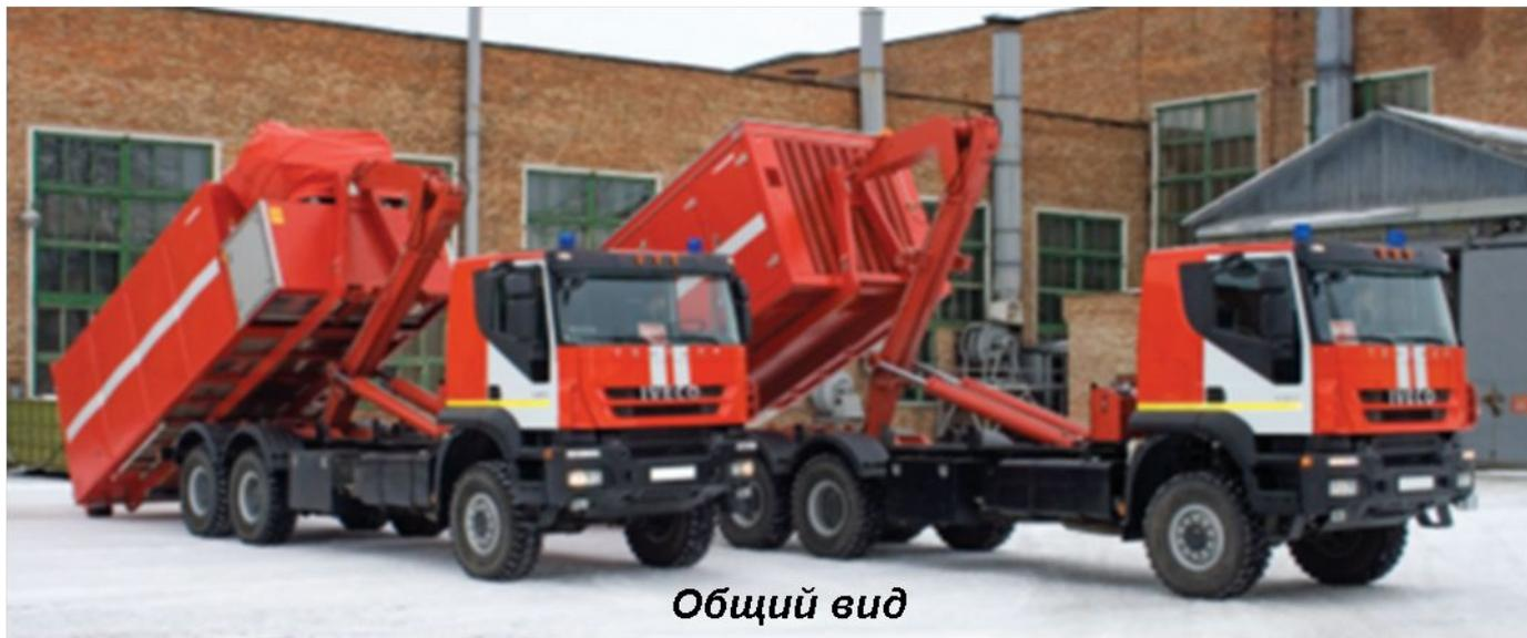
Комплекс КНРМ 350-1,5/300 «Шквал» предназначен для доставки к месту пожара (аварии) личного состава, пожарно-технического вооружения, оборудования для подачи и откачки больших объемов воды, механизированной прокладки и уборки магистральных рукавных линий, в том числе в условиях труднопроходимой местности.
