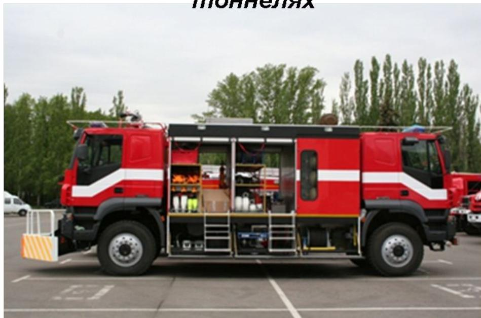
Особенностью автомобиля ПСА-Челнок является наличие модуля, предназначенного для эвакуации людей при авариях в тоннелях. Пространство салона обеспечивает эвакуацию 20 человек (10 сидячих и 10 стоячих мест). Автомобиль оснащен системами жизнеобеспечения боевого расчета, орошения кабины, обеспечения работы двигателя в условиях задымления, а также поддержки работы водителя в задымленной среде (тепловизионное устройство).
