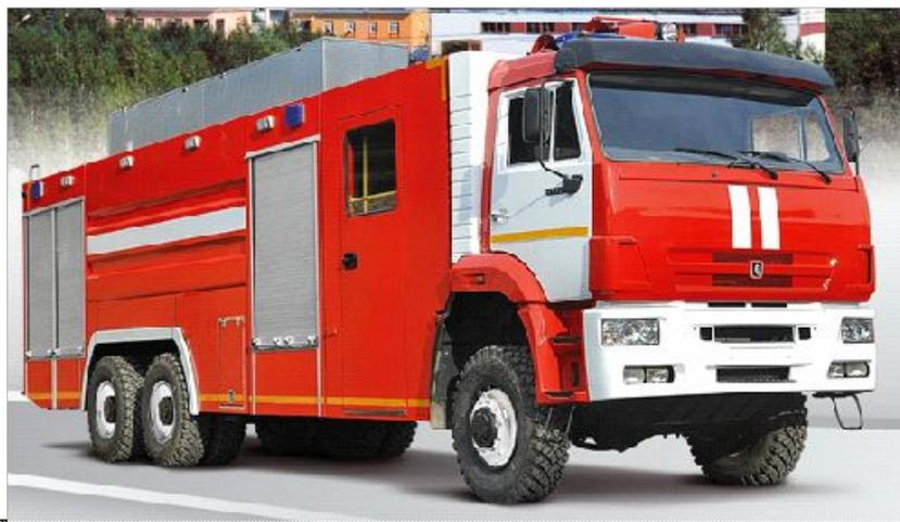
Уникальность данного автомобиля заключается в наличии увеличенного запаса огнетушащих веществ (воды – 10 тонн, пенообразователя – 2 тонны), расширенного комплекта пожарнотехнического вооружения и аварийно-спасательного оборудования, а также способности подвдвдть в очаг пожара воду или воздушно-механическую пену через высокопроизводительный стационарный лафетный ствол или переносные лафетные стволы.
