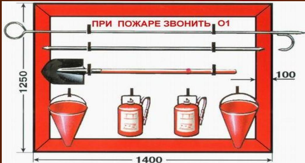
**ПРЕДНАЗНАЧЕН** для размещения первичных средств пожаротушения, немеханизированного инструмента и пожарного инвентаря в производственных и складских помещениях, не оборудованных противопожарным водопроводом и автоматическими установками пожаротушения, а также на территории предприятий, не имеющих наружного противопожарного водопровода, или при удалении зданий (сооружений), наружных технологических установок на расстояние более 100 м от наружных пожарных водоисточников.
