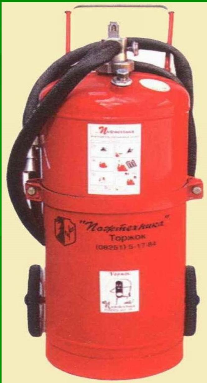
Принцип работы передвижного огнетушителя ОП-50(3) основан на вытеснении огнетушащего порошка (при открытом клапане запорного устройства) сжатым воздухом, находящимся в емкости.
