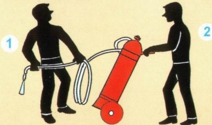
Номер 2 срывает пломбу и поворачивает рычаг на себя до отказа
