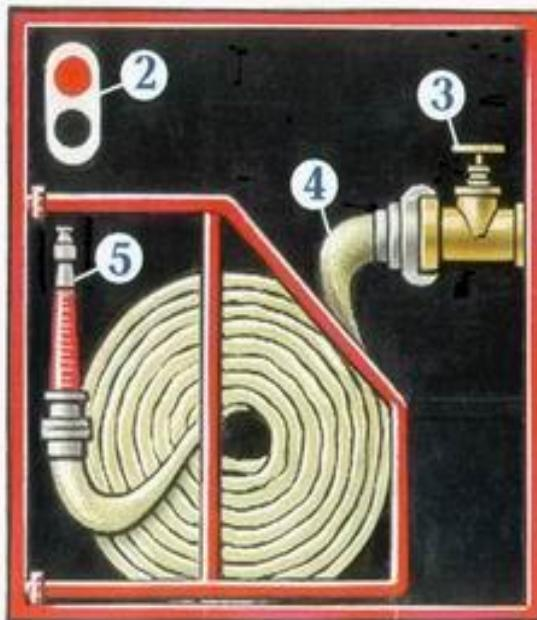
ПРЕДНАЗНАЧЕН для тушения пожаров и загораний веществ и материалов, кроме электроустановок под напряжением
