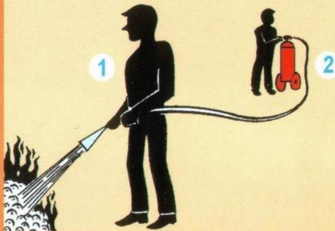
При работе углекислотных огнетушителей всех типов запрещается держать расстрub незащищенной рукой, так как при выходе углекислоты образуется снегообразная масса с температурой минус 80°C.
