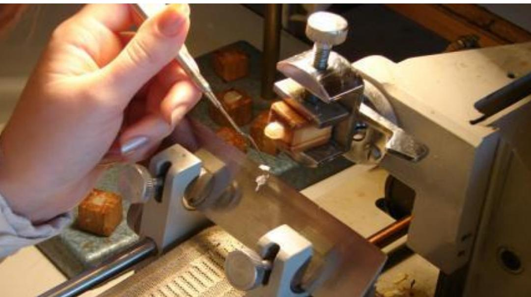
4) **Резка**, или микромирование, представляет собой изготовление тонких срезов на специальном приборе — микротоме. Толщина срезов, предназначенных для световой микроскопии, не должна превышать 4 — 5 мкм, для электронной — 50 — 60 нм.
