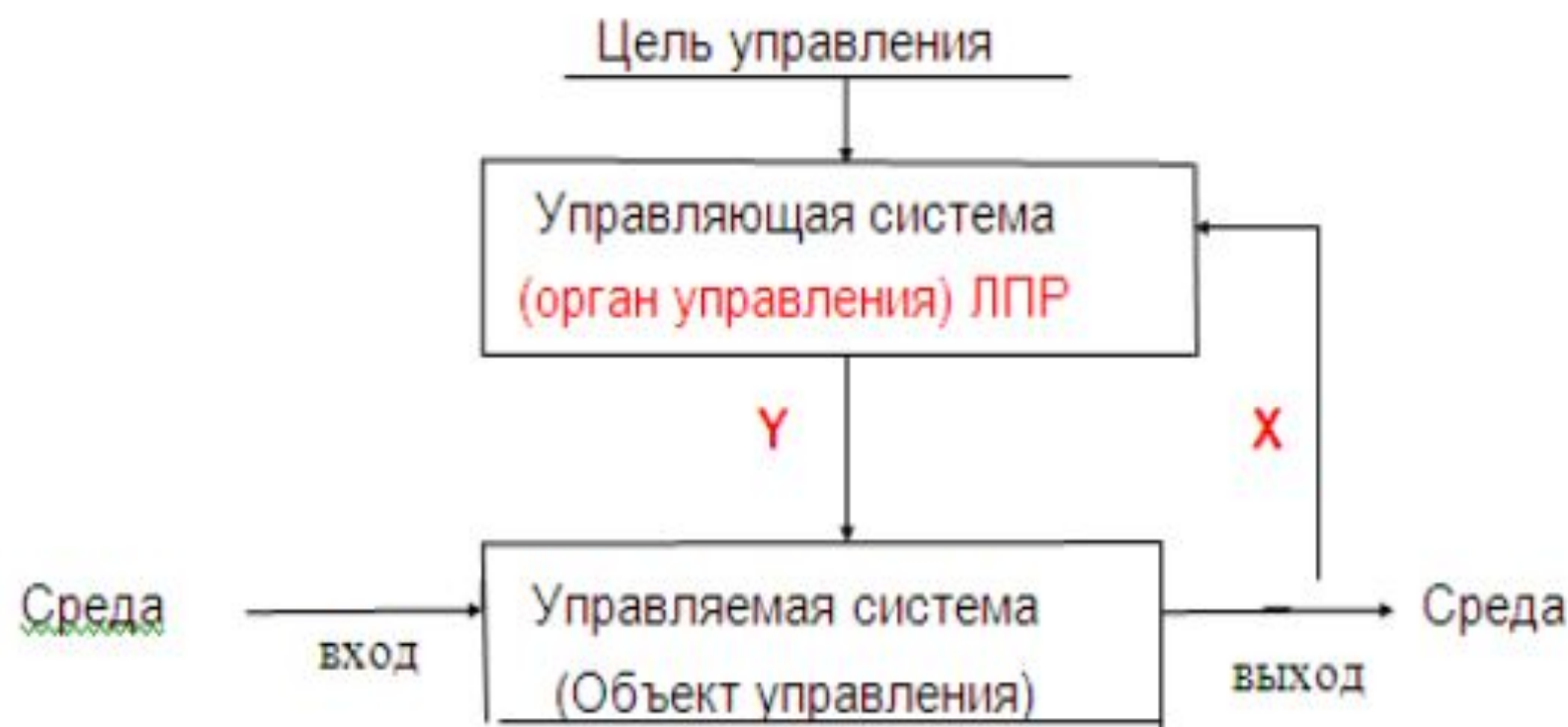
Рис. Пример СУ с обратной связью
