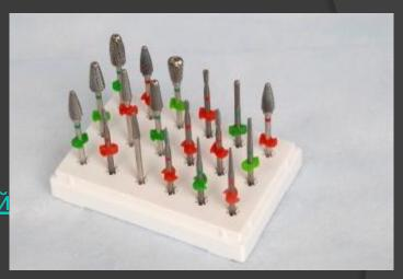
Фрезы ТВС применяются для обработки материалов при проведении зуботехнических работ
