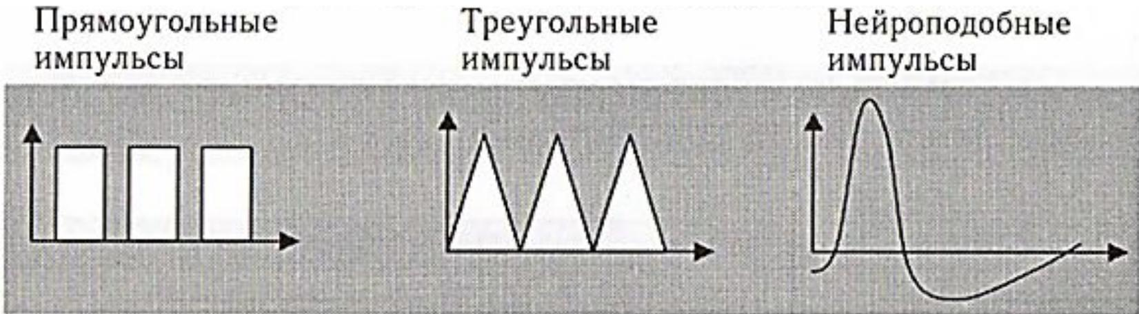
Во многом от формы импульса зависит характер ощущений и эффективность воздействия через кожу. Высокой эффективностью отличаются биполярные импульсные токи нейроподобной формы, которые являются адекватным раздражителем для мышц.
