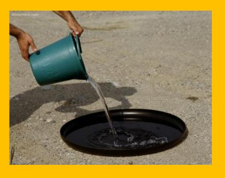
• Watercone представляет собой конус, который помещается на лоток с соленой водой (либо на какое-либо топкое место или влажную землю), и оставляется на солнце. Вода начинает испаряться, конденсат стекает по стенкам конуса, и к концу дня вы просто его переворачиваете, снимаете колпачок с верхушки, и пьете воду.
