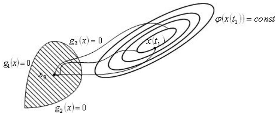
Терминальная задача управления отрезками на конец траектории
