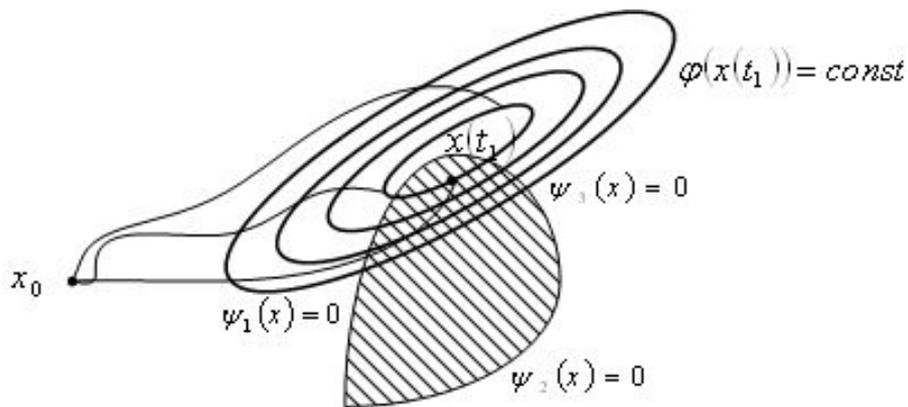
Терминальная задача управления отрезками на конец траектории
