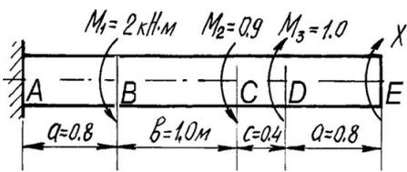
3). Подбор диаметра поперечного сечения бруса.
