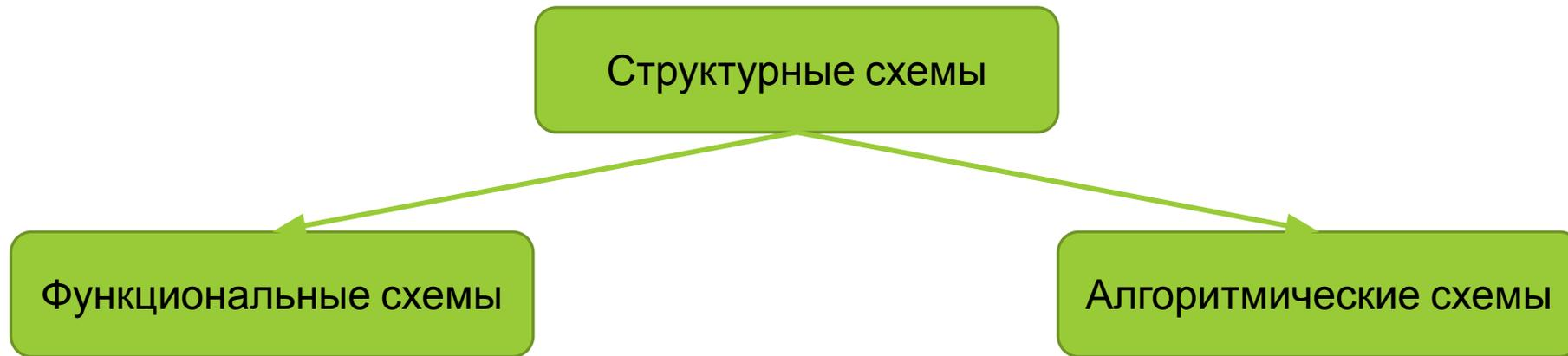
**Структурная схема** системы управления графически отображает ее состав; входящие в эту систему элементы и связи между ними.
