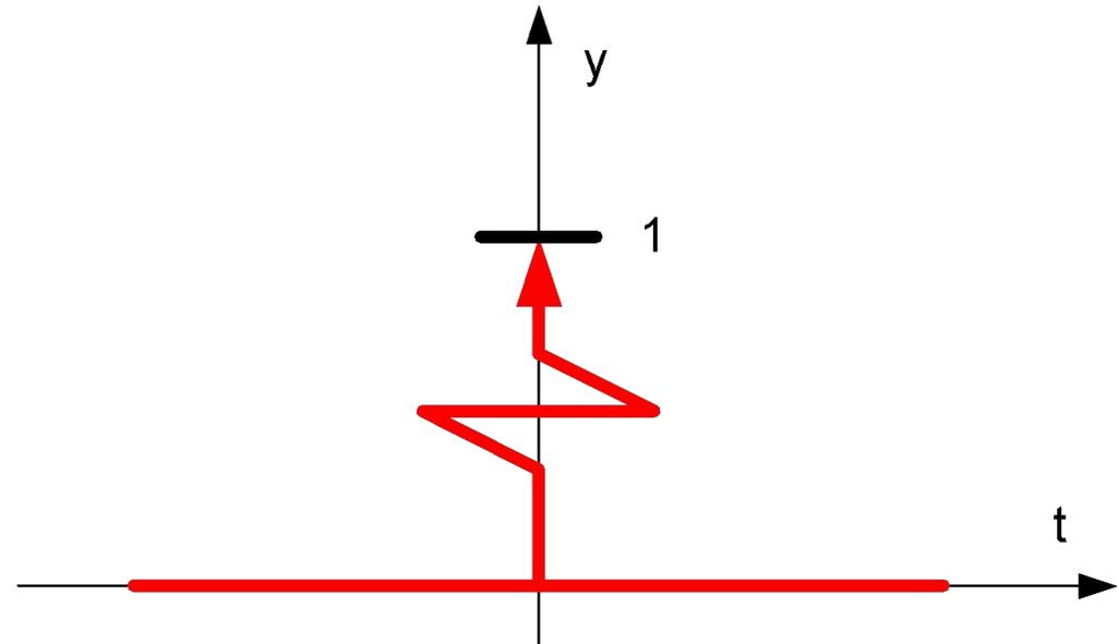
**Импульсная переходная характеристика** – это реакция объекта/системы на функцию Дирака. Импульсная переходная характеристика представляет собой производную от переходной характеристики, обозначается  $w(t)$ .
