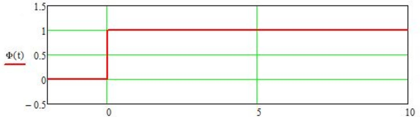
**Переходная характеристика** – это реакция объекта/системы на функцию Хевисайда. Переходная характеристика обозначается  $h(t)$ .
