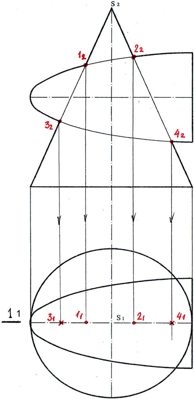
2. Проверяем, можно ли еще взять вертикальные плоскости-посредники, параллельные П2. В сечении по конусу получим гиперболу, по параболоиду вращения - параболу. Обе кривые требуют времени для построения. **Вывод: больше вертикальные плоскости использовать нельзя.**
