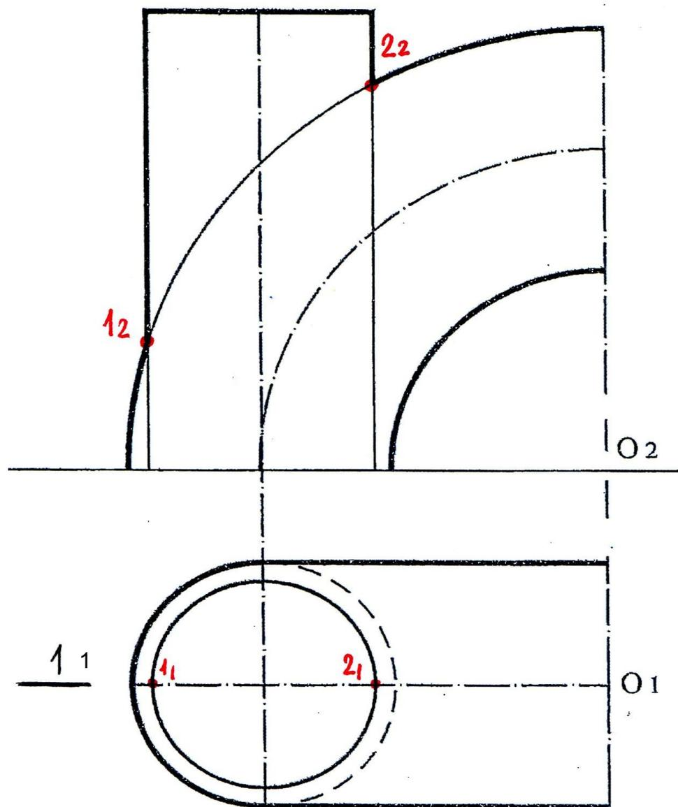
2. Далее применим **метод эксцентрических сфер - посредников**. Через ось тора (центр  $O_2$ ) проведем фронтально-проецирующую **плоскость 2 ( $2_2$ )**, которая разрежет тор по окружности с центром в точке  **$N$  ( $N_2$ )** (на  $\Pi_2$  окружность совпадает с проекцией плоскости  $2_2$ ). Восстановим к плоскости окружности перпендикуляр в **(.)  $N$  ( $N_2$ )** и найдем его пересечение с осью цилиндра **-(.) $K$  ( $K_2$ )** - это **центр сферы-посредника**
