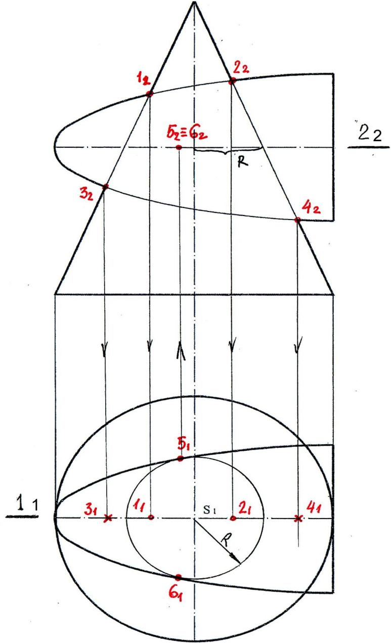
4. Проверяем, можно ли еще использовать горизонтальные плоскости - посредники. В сечении по конусу получаем окружности, а в сечении по параболоиду – параболы, построение которых занимает много времени. **Вывод: кроме плоскости 2 больше использовать горизонтальные плоскости не целесообразно.**
