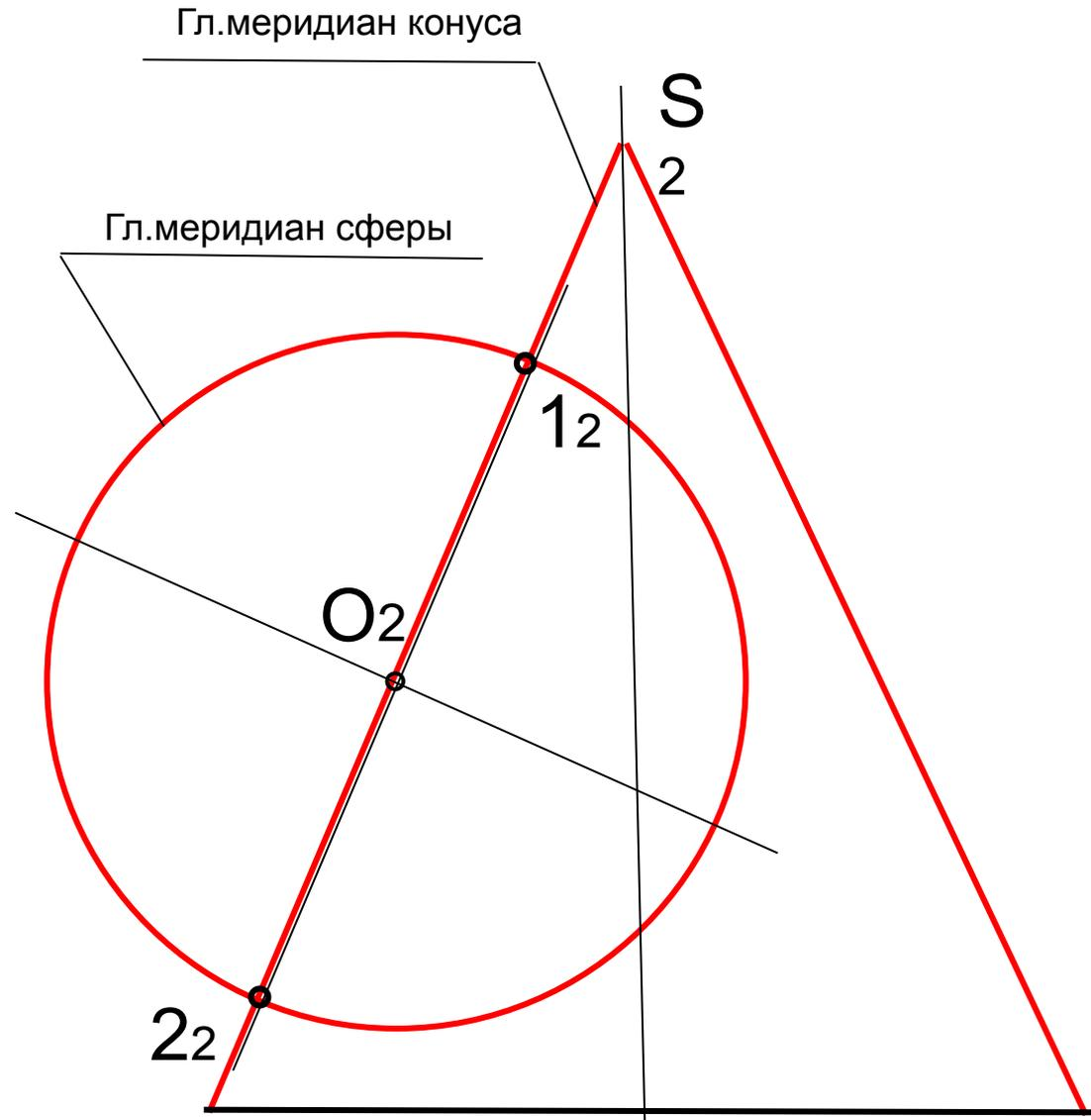
Т.к. обе поверхности являются поверхностями вращения, они соосны и оси обеих поверхностей параллельны П2- можем применить метод концентрических сфер-посредников.
