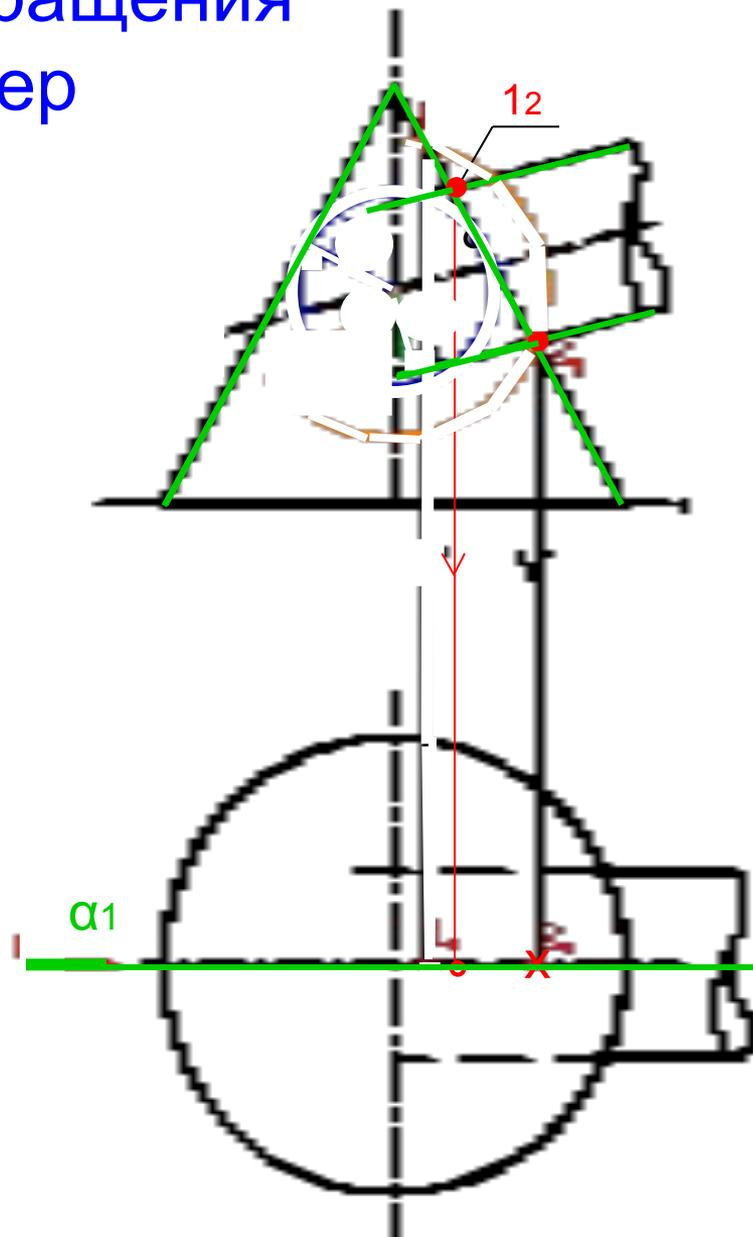
Определяем радиус минимальной сферы (должна коснуться обеих поверхностей или коснуться одной и пересечь другую). Сфера радиуса  $R_c$ , касательная к цилиндру, не имеет общих параллелей с конусом.
