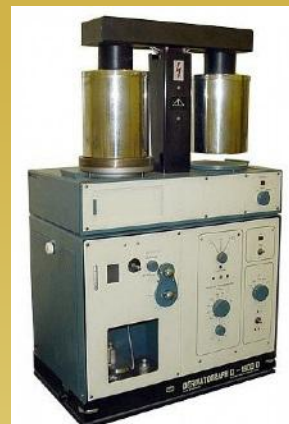
Дериватограф Q-1500 («МОМ», Венгрия), с программным обеспечением, созданным в среде LabVIEW 8.6.1
