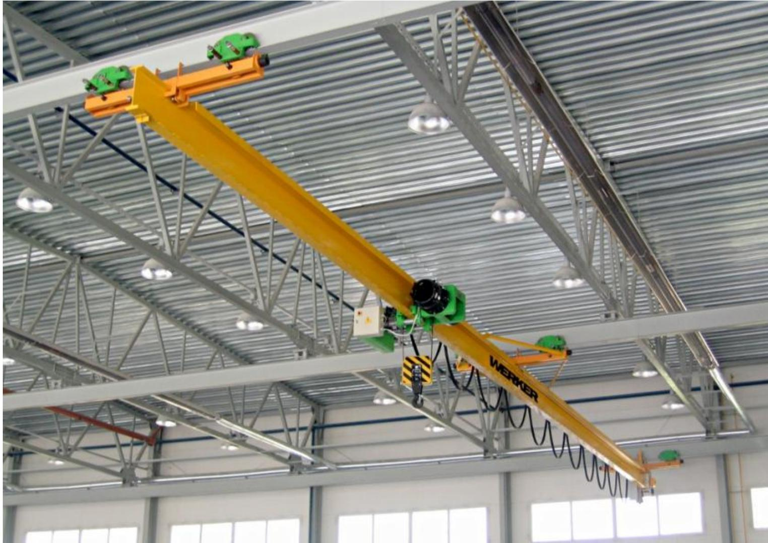
Подвесные краны имеют грузоподъемность от 2,5 до 50 кН (5 тонн), редко до 200 кН. Состоят из легкого моста или несущей балки, двух- или четырехкатковых механизмов передвижения по подвесным путям и электротали, которая перемещается по нижней полке мостовой балки
