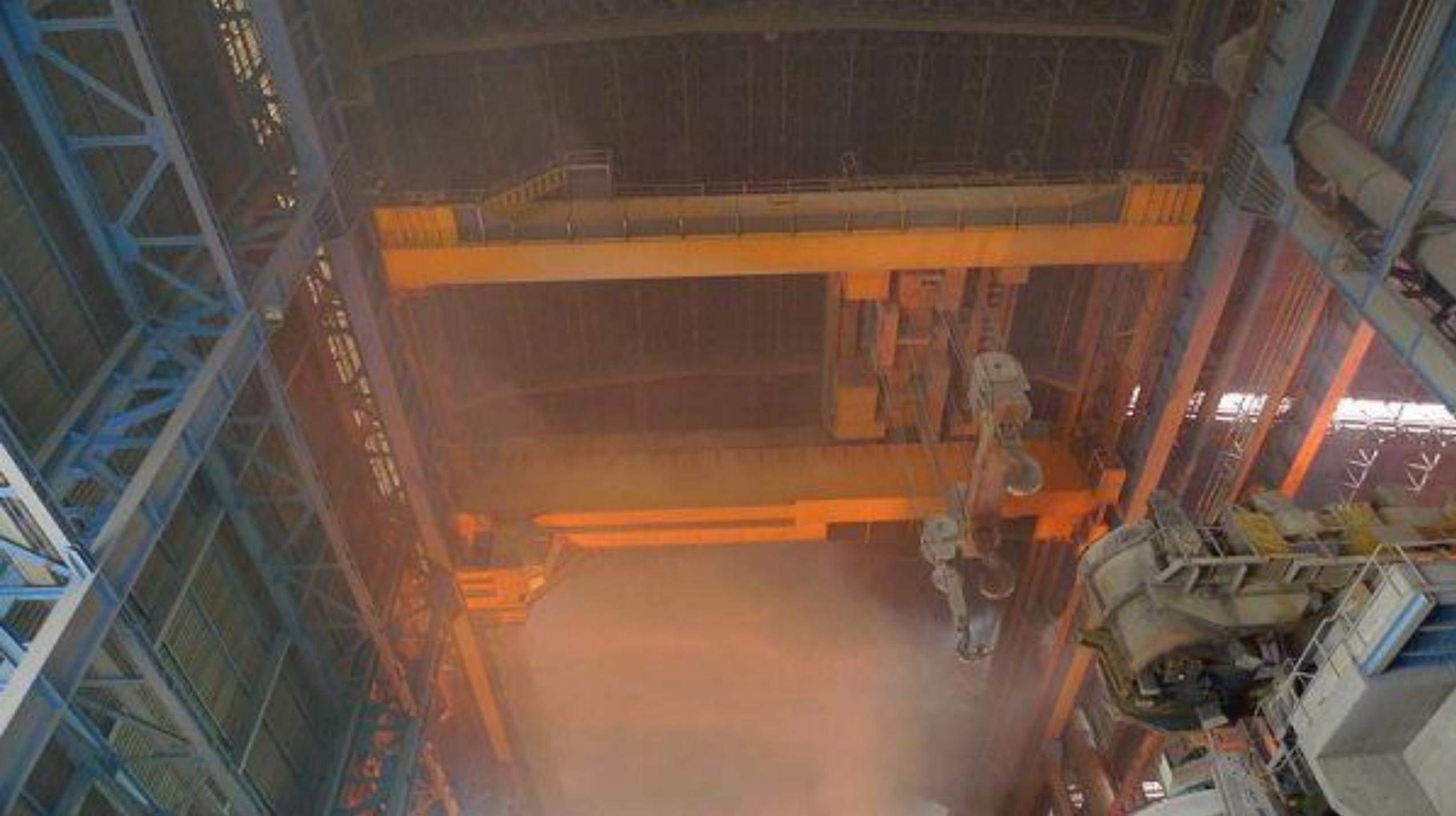
Мостовой кран – металлическая мостовая конструкция, на опорах которой установлены тележки. Благодаря тележкам кране передвигается вдоль пролёта здания.
