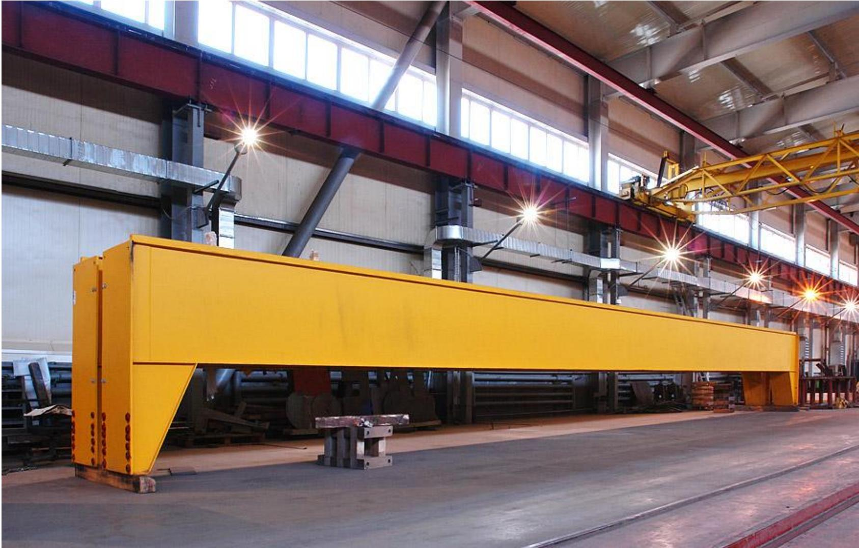
Колёса тележек направляются рельсами, которые уложены по подкрановым балкам, укреплённым на колоннах здания. Вдоль моста крана передвигается тележка с электролебедкой и крюком для подъёма и опускания груза. Механизм подъема и спуска груза тоже размещен на крановой тележке.
