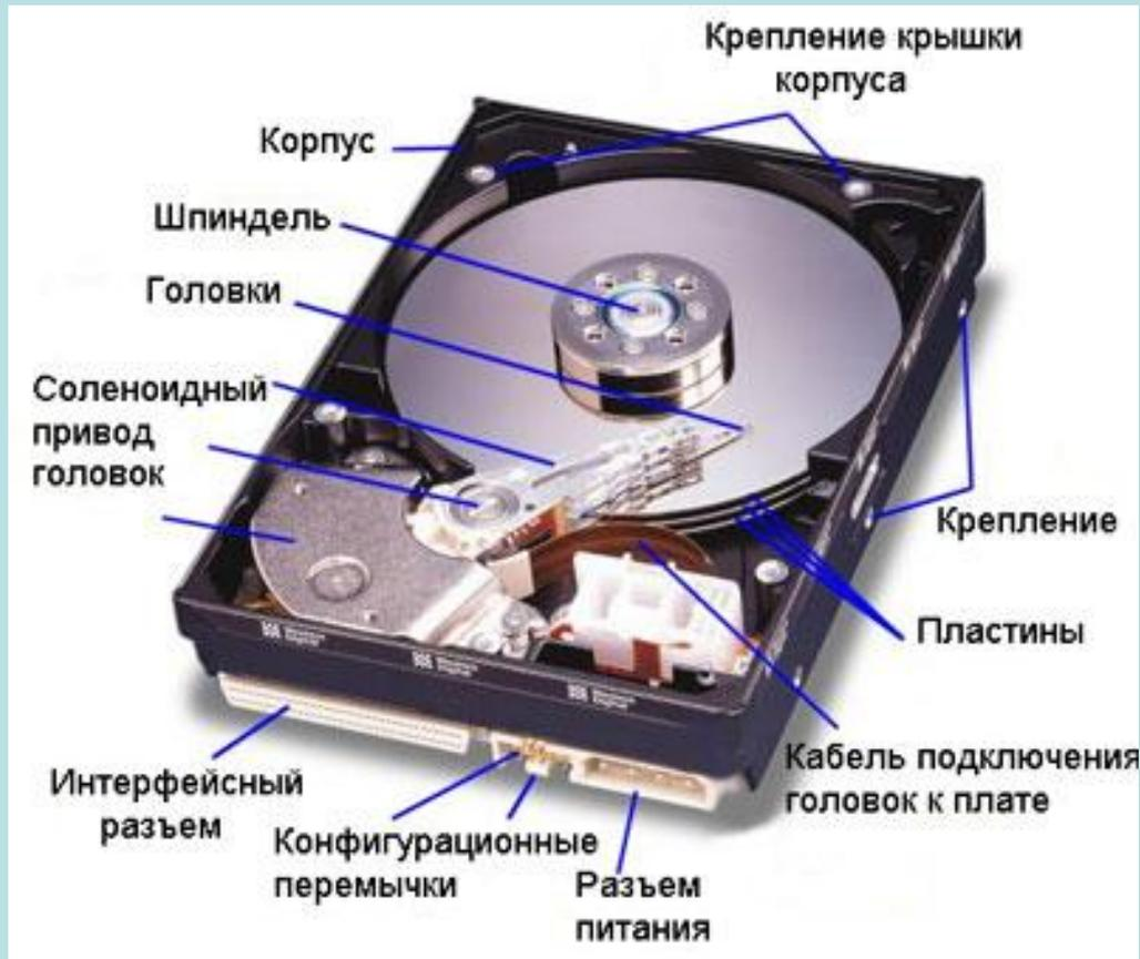
За счет использования нескольких дисковых пластин и гораздо большего количества дорожек на каждой стороне магнитных пластин информационная емкость жестких дисков может достигать 750 Гбайт.
