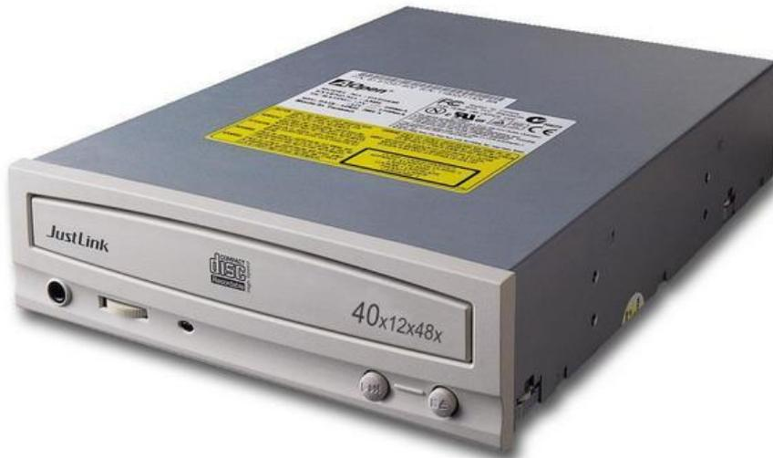
Запись CD-RW дисков производится на меньшей скорости, поэтому CD-дисководы маркируются тремя числами «скорость записи CD-R» × «скорость записи CD-RW» × «скорость чтения» (например, 40×12×48)
