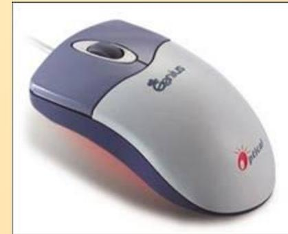
**Мыши имеют обычно две кнопки управления, которые используются при работе с графическим интерфейсом программ. В настоящее время появились мыши с дополнительным колесиком, которое располагается между кнопками. Оно предназначено для прокрутки вверх или вниз не уместяющихся целиком на экране изображений, текстов или Web-страниц.**
