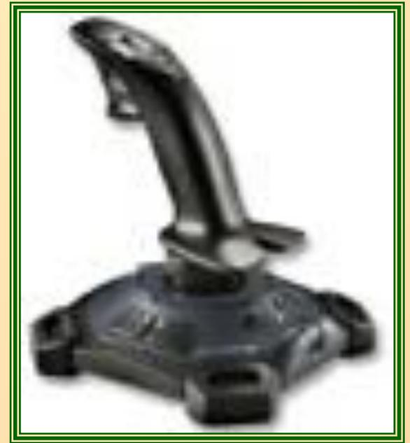
Джойстик – это манипулятор в виде штурвала, предназначен в основном для игр типа авиасимуляторов, космических баталий, симуляторов кораблей и подводных лодок. В джойстиках управление аналоговое, то есть сила воздействия на управляемый объект прямо пропорциональна уровню наклона ручки. Для правильного функционирования джойстик
