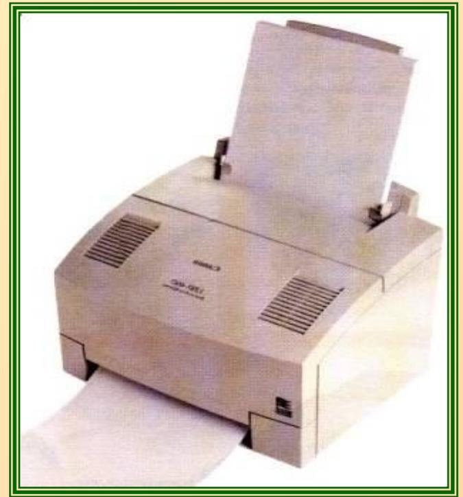
**Изображение страницы создается на электростатически заряженной бумаге лазерным лучом. Когда бумага проходит над емкостью с электрически заряженным сухим тонером (красящим порошком), она притягивает тонер к некоторым зонам бумаги и отталкивает его от других. Затем красящий порошок буквально вплавляется в бумагу путем нагревания и давления со стороны системы плавления.**
