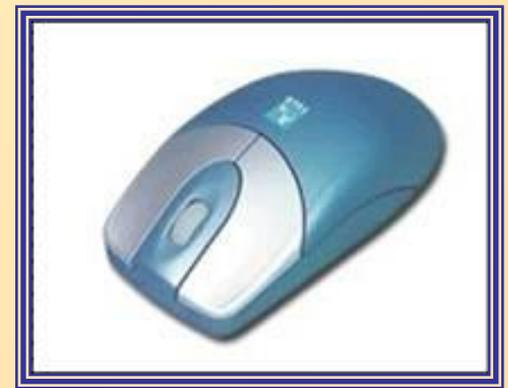
**Все мыши работают почти одинаково. Шарик внутри мыши трется о ролики. На конце каждого ролика есть диск и сенсор для обнаружения движения. Также вращение шара передается двум пластмассовым валам, положение которых с большой точностью считывается инфракрасными оптопарами (то есть парами "светоизлучатель-фотоприемник"). Один ролик поворачивается при движении мыши слева направо, а другой - при движении назад и вперед. Эти движения фиксируются в инструкции экранного указателя.**
