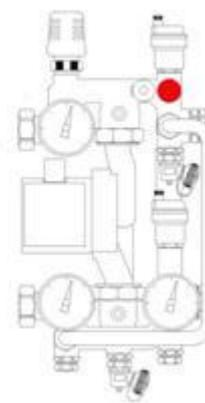
Если перепускной клапан сработает во время настройки узла, то настройка будет некорректной. Поэтому его следует выставить в положение, при котором он не сработает
