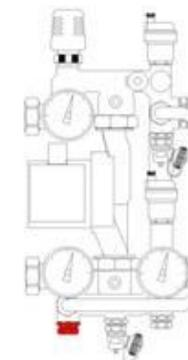
Закрываем Балансировочно-запорный клапан первичного контура. Для этого откидываем крышку клапана и шестигранным ключом поворачиваем клапан против часовой стрелки до упора.
