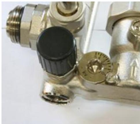
При помощи этого клапана задаётся соотношение расходов теплоносителей первичного и вторичного контуров, то есть задаётся температура теплоносителя в подающем трубопроводе вторичного контура. Поворот клапана осуществляется шестигранным ключом, для предотвращения случайного поворота во время эксплуатации клапан фиксируется зажимным винтом. На клапане имеется шкала со значениями пропускной способности клапана от 0 до 5 м<sup>3</sup> час.
