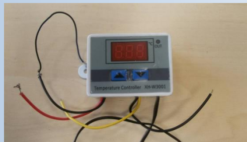
Температурное реле (2 шт.)
