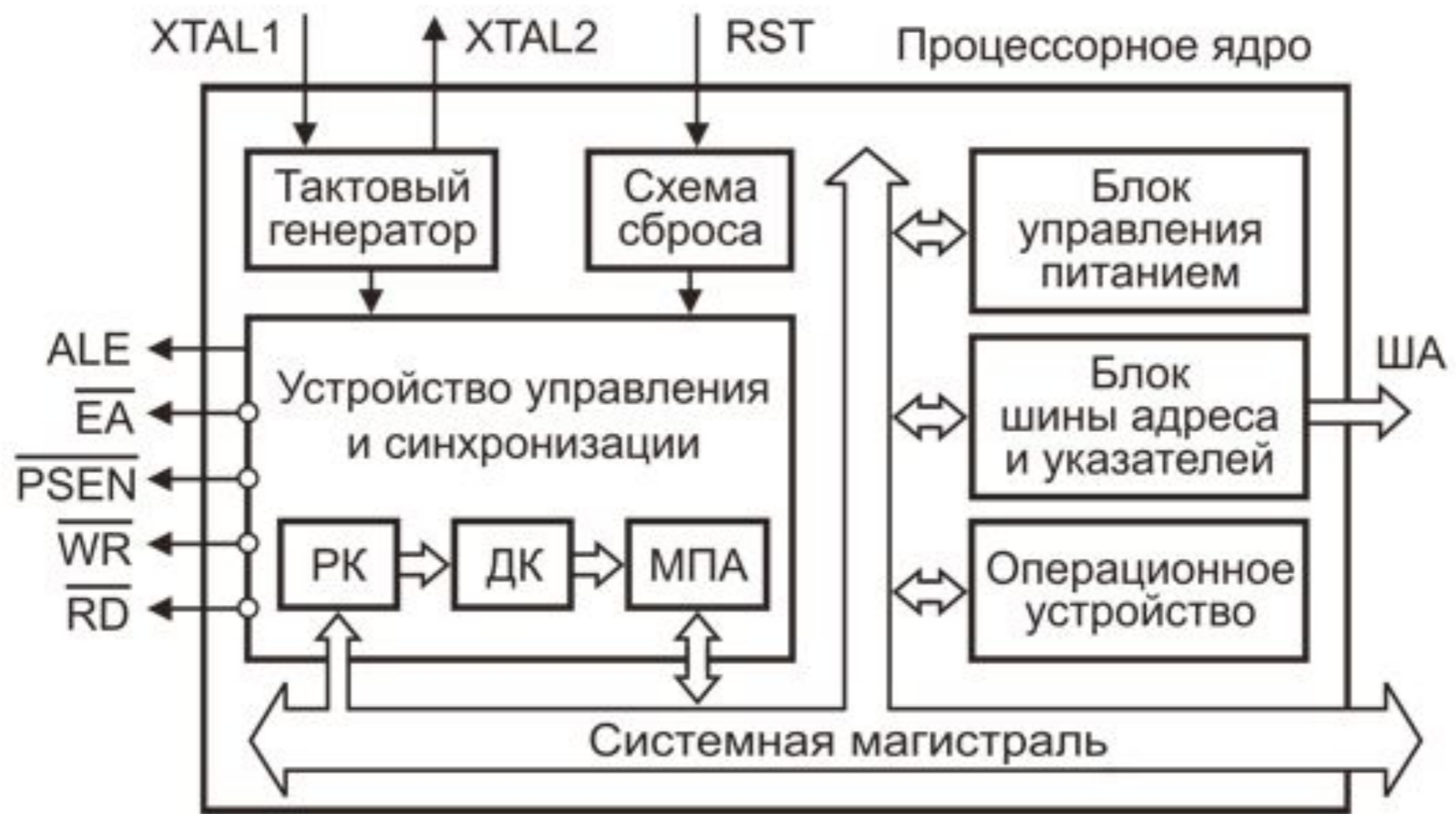
Рис. 2.2. Структура процессорного ядра микроконтроллера 8051
