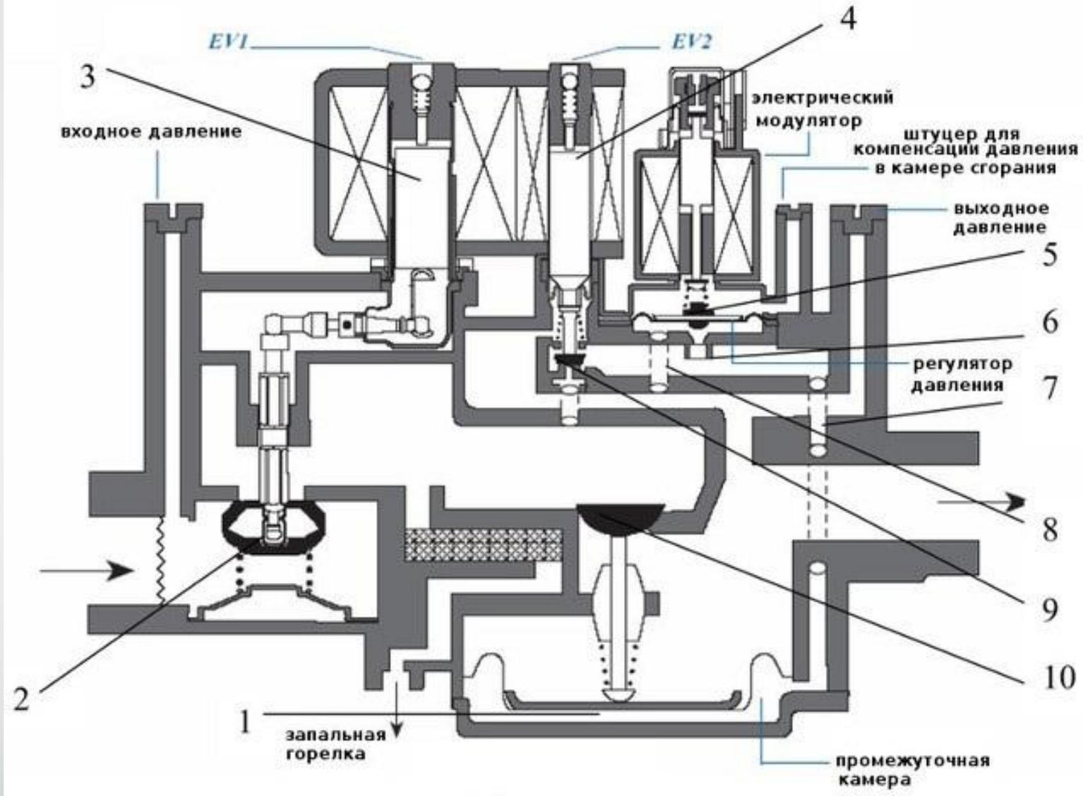
В случае пропадания газа или электроэнергии, пружины встроенные в блок автоматики автоматически закрывают клапан, прекращая подачу газа.
