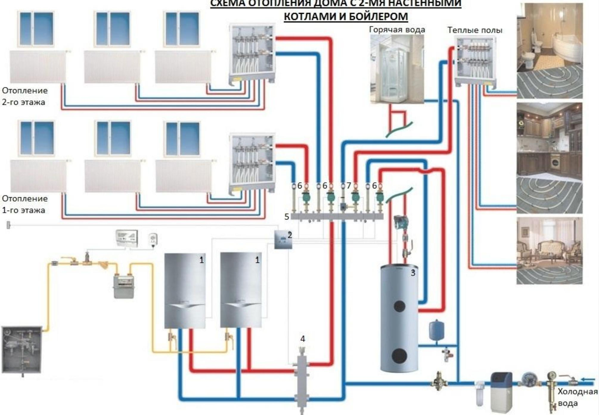
1. Котлы газовые настенные одноконтурные VAILLANT turboTEC VU
