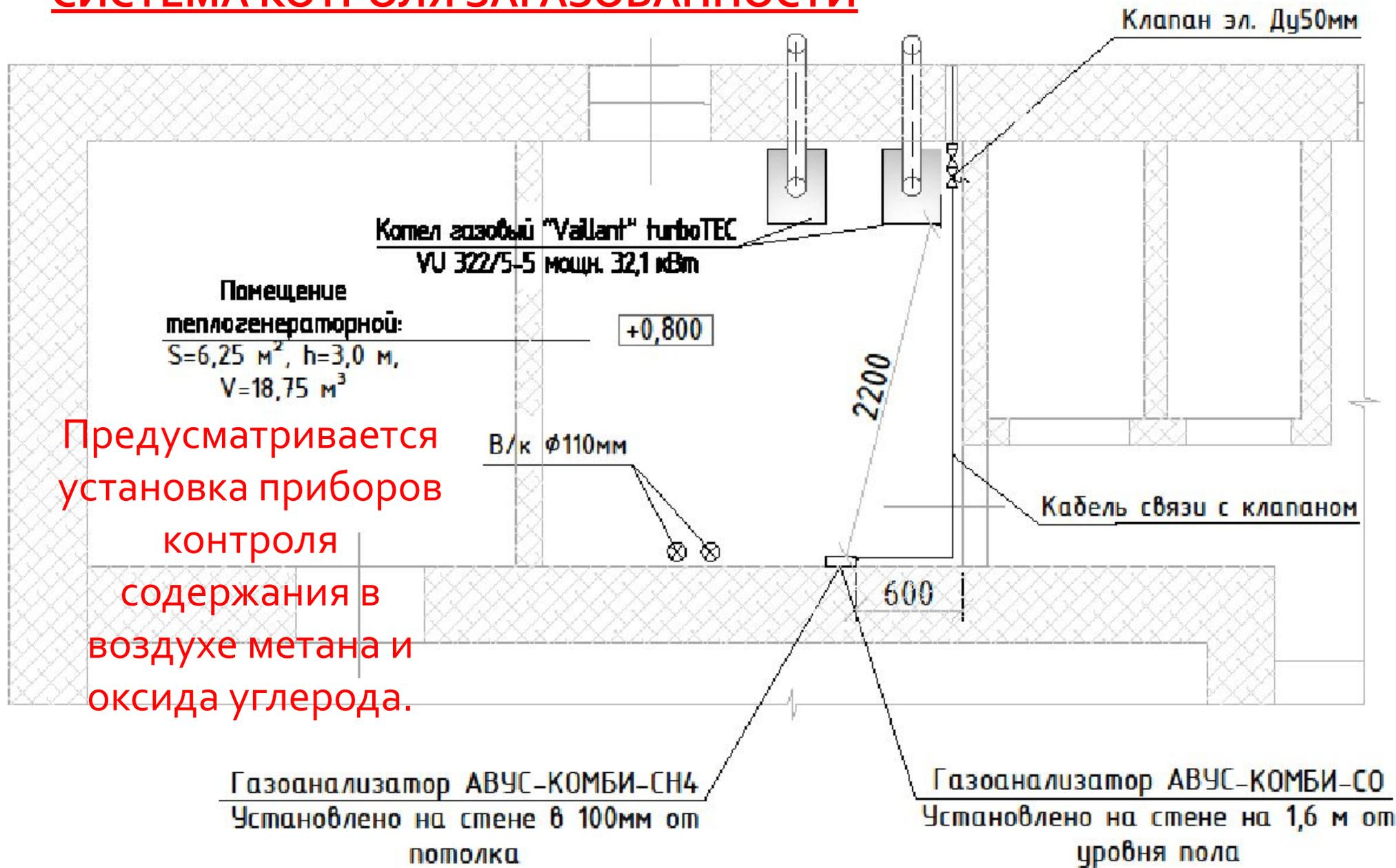
Предусматривается установка приборов контроля содержания в воздухе метана и оксида углерода.
