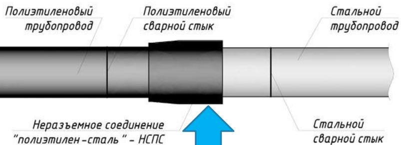
Неразъемное соединение ПЭ/сталь 63/57мм выполняется в стальном футляре в в/у изоляции
