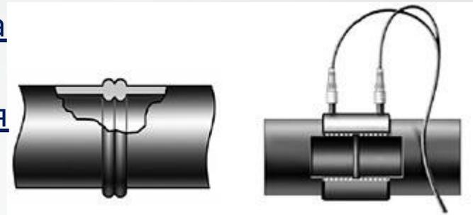
Соединение п/э труб между собой выполняется муфтами с закладными нагревательными элементами или встык
